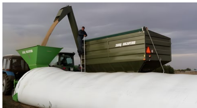
Использование ПБН-30 для подачи зерна в ЗПМ-180.
