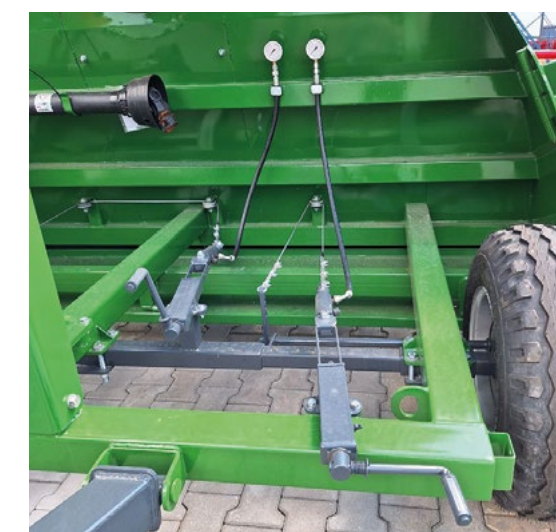
Регулировка давления в тормозной системе для каждого колеса отдельно
