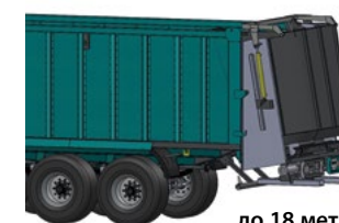
Опция: задна стена за разпръскване на тор и птичи тор с долни плочи (разпръскване до 24 м)
