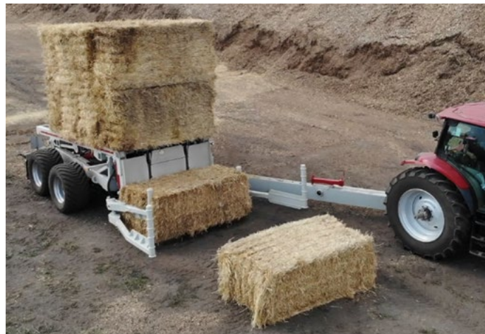
Повдигане на 2 бали едновременно
