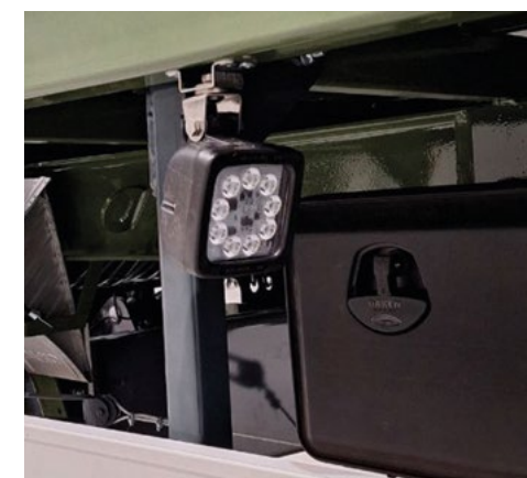
Странични и задни LED светлини за осветяване на технологичната лента на терена
