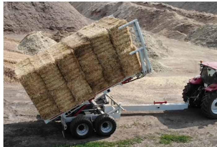
Разтоварването на полуремаркетото за бали върху равна и твърда повърхност отнема 30-40 секунди
