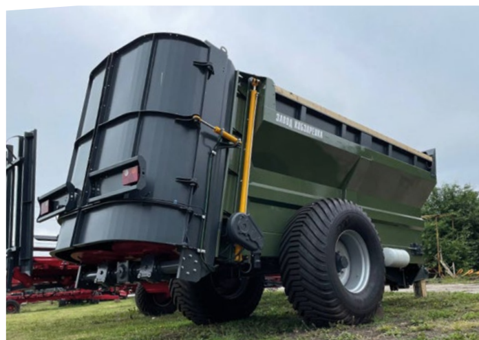
Задна хидравлично отваряема стена
