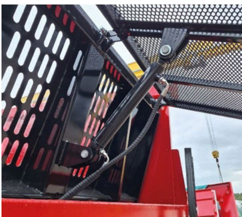
Хидравлично отваряща се мрежа на плъзгаща се стена
