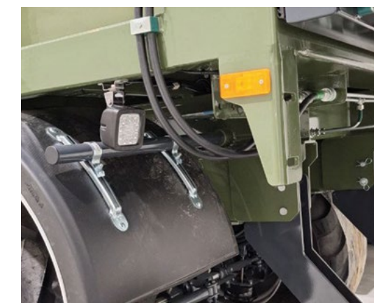
Странични и задни LED светлини за осветяване на технологичната лента на терена
