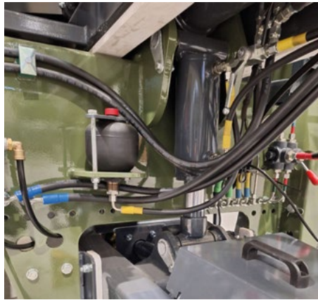
Теглич с хидравлично регулиране на височината на трактора и хидравличен демпфер с хидроаккумулятор.
