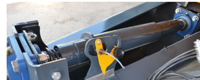
Регулатор на торсионно натоварване, който при пикови натоварвания спира потока към разпръскващите битери, блокирайки подаването на масло към хидравличния цилиндър
