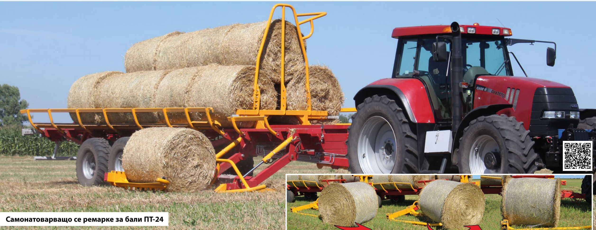
Универсалната хидравлична лапа в движение разгъва ролката и товари на платформата
