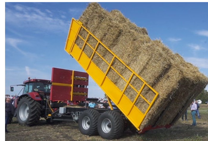
Разтоварването на полуреамаркетото за бали върху равна и твърда повърхност отнема 30-40 секунди
