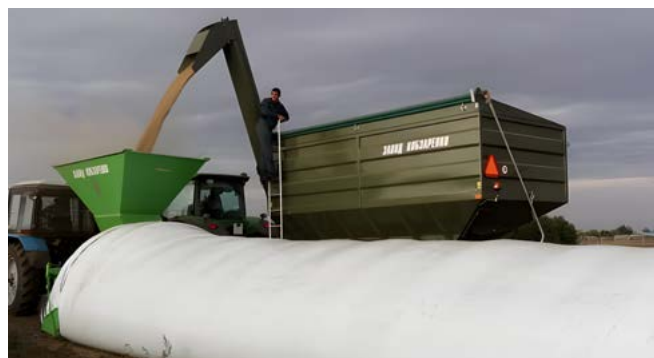
Використання ПБН-30 для подачі зерна в ЗПМ-180
