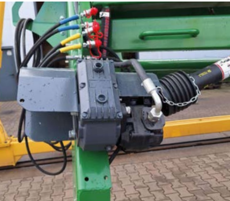
Автономна маслозаправна станція. Для збільшення подачі мастила на гідромотор.
