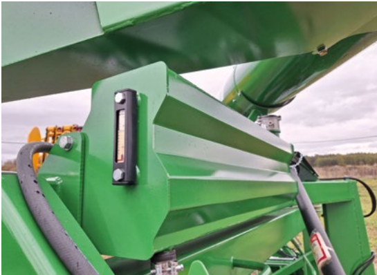
Додатни резервоар за уље са термометром
