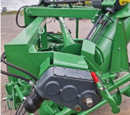
Механизам за намотавање и уклањање вреће
