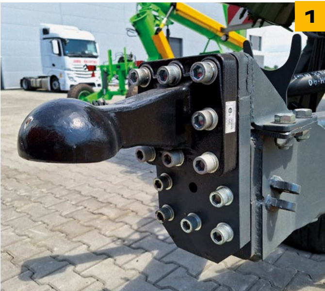
АДАПТЕР ДЛЯ РЕГУЛЮВАННЯ ВИСОТИ ДЛЯ ПРИЄДНАННЯ БУДЬ-ЯКОГО ТРАКТОРА
