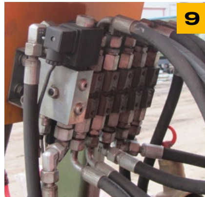
ЕЛЕКТРОБЛОК ПІДКЛЮЧЕННЯ 5-ТИ ПАР ВИХОДІВ
