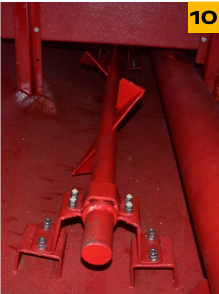
МЕХАНІЧНА МІШАЛКА З ГІДРОПРИВОДОМ
