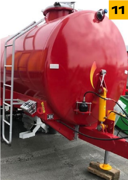
РЕГУЛЮВАННЯ ВИСОТИ ПІДЧЕПЛЕННЯ І НАХИЛУ БОЧКИ
