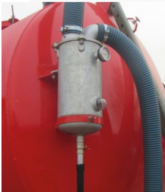
Сифон запобігає потраплянню жижі в насос
