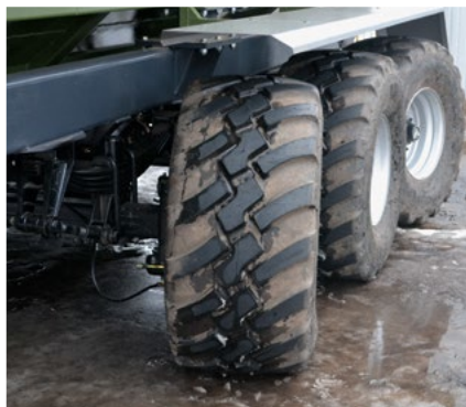
HÜDRAULISELT PÖÖRAVAD ESIMENE JA VIIMANE TELG (PBN-40 JA PBN-50)
