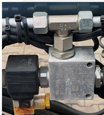
HÜDRAULILINE VENTIIL SIIBRI AVAMISE BLOKEERIMISEKS FIKSEERITUD PTO- TRAKTORI PUHUL.
