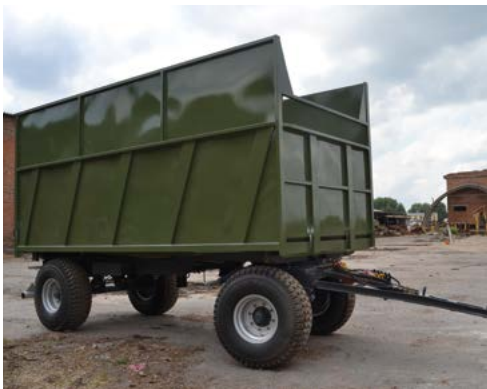
2TСП-14 щеповоз с объемом кузова 24 м³
