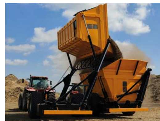
Максимальная высота разгрузки 4000 мм.
