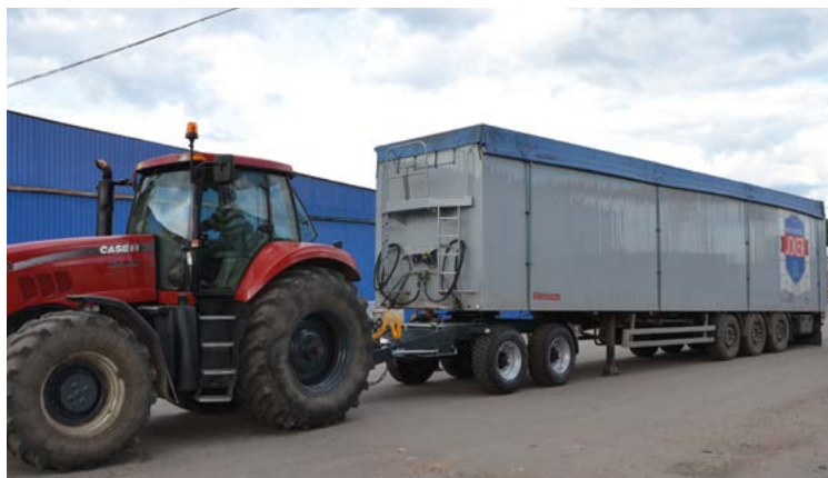
Соединение ПСП-20 Долли с автомобильным полуприцепом и трактором
