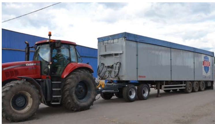
З'єднання ПСП-20 Доллі з автомобільним напівприцепом та трактором
