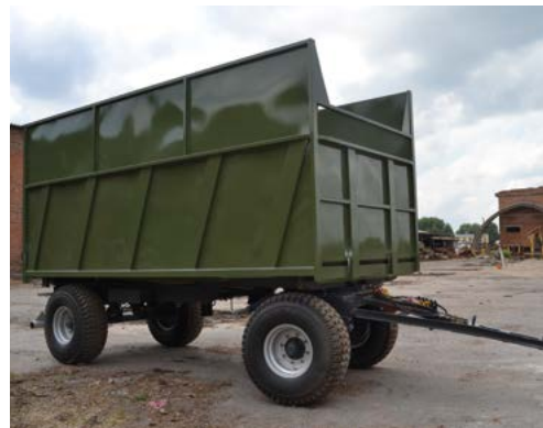
2ТСП-14 щеповоз з об'ємом кузова 24 м³
