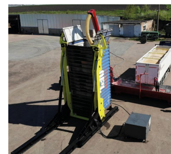
Ise eemaldab ja paigaldab konteineri otse konteineriveokilt
