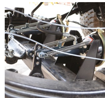
Комбинированная тормозная система
