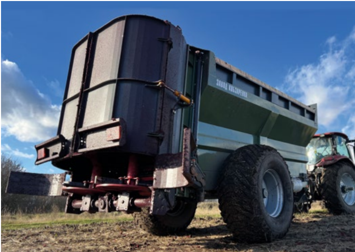
Задняя стенка открывается гидравлически
