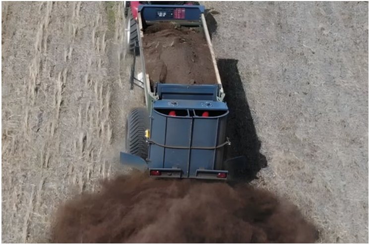
Внесение органических удобрений нижними пластинами – минимальная норма
