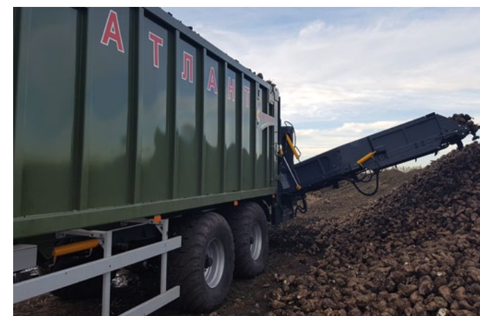
Кагатиловщик свеклы на высоту до 3,0м.
