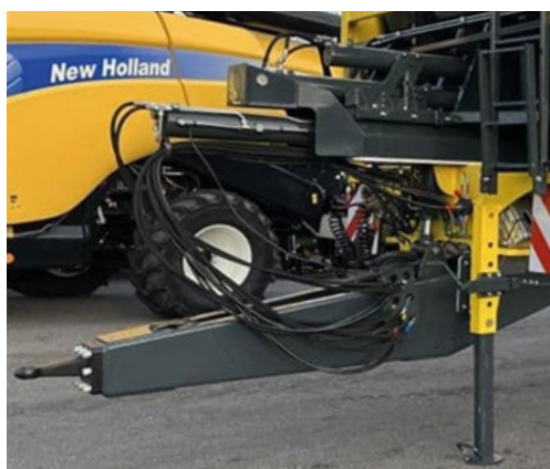
Механическая опора дышла
