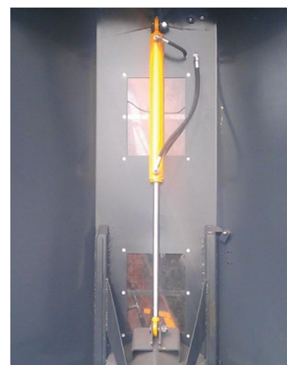
Гидравлически закрываемая заслонка
