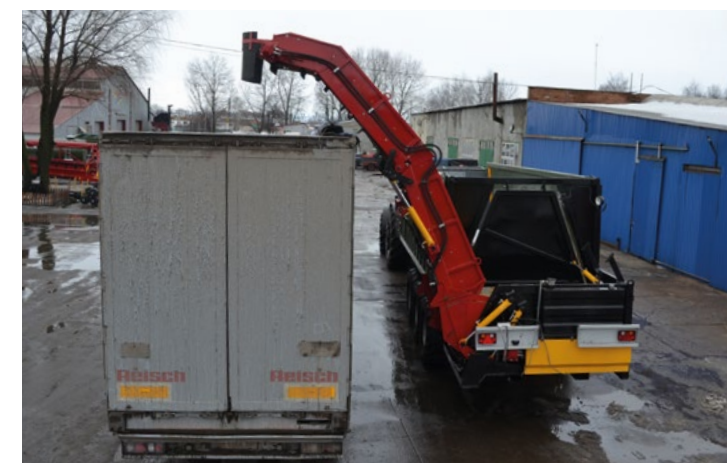
Перегрузчик свеклы на высоту до 4,5м.
