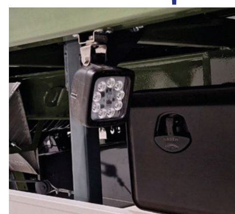
Боковые и задние светодиодные фонари для освещения технологической дорожки на поле
