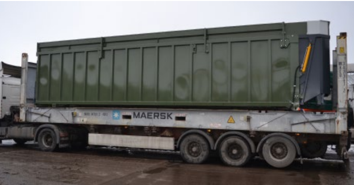
Кузов АЗП-60 для установки на контейнеровоз
