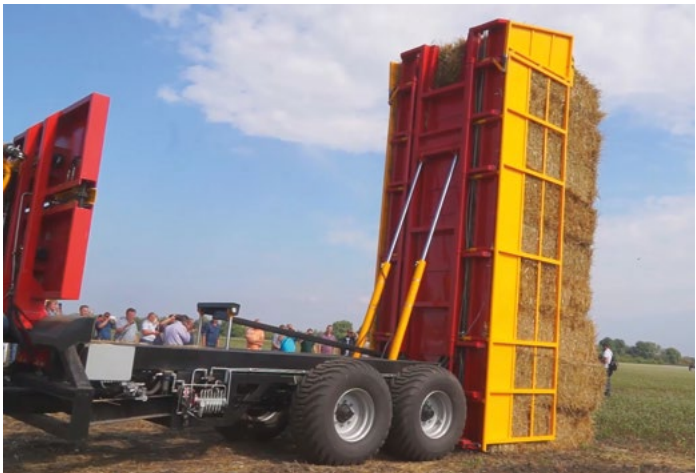
Скирдование тюков без привлечения дополнительной техники
