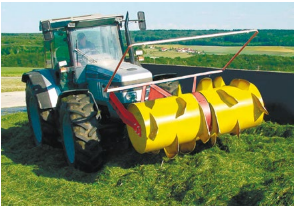
Разравниватель силоса РС-2400
