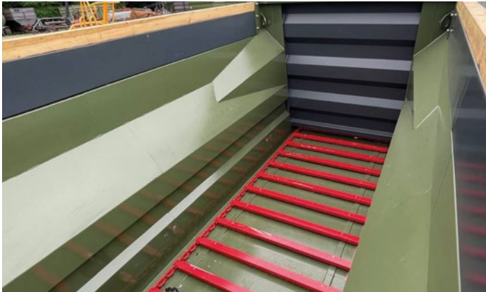
Планчатый транспортер шириной 1,3м.
