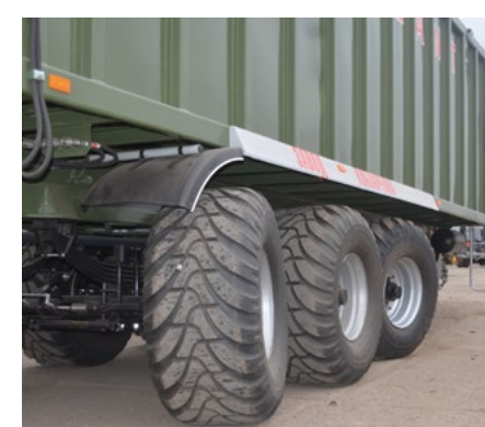
Первая и третья управляемые оси
