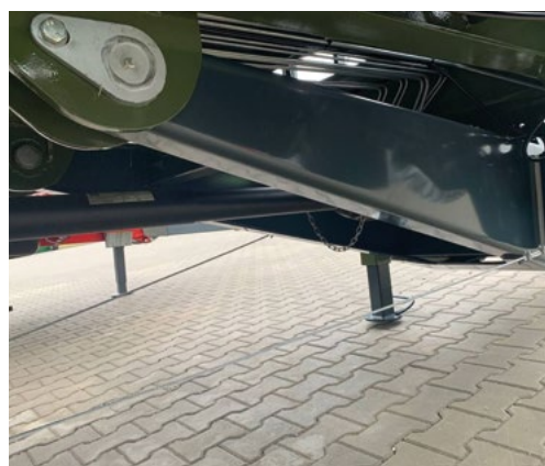
Механическая опора дышла
