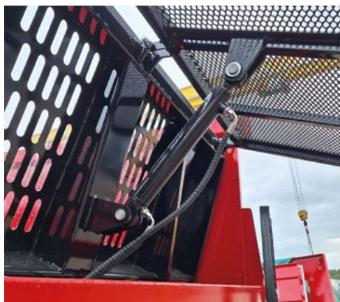
Гидравлически открываемая сетка на раздвижной стенке
