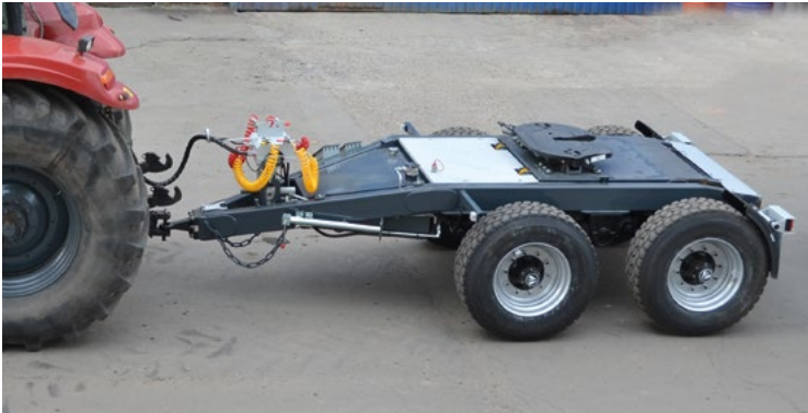
Подкатный седельный полуприцеп ПСП-20 ДОЛЛИ
