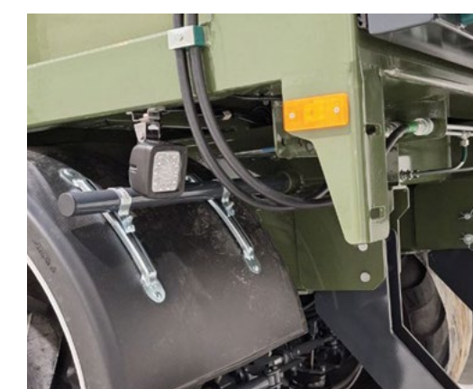
Боковые и задние светодиодные фонари для освещения технологической дорожки на поле
