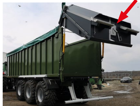
Задний клапан для выгрузки зерна
