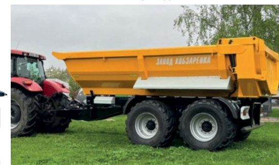
Tee ehitus poolhaagis TSP-12b, valmistatud Hardox terasest
