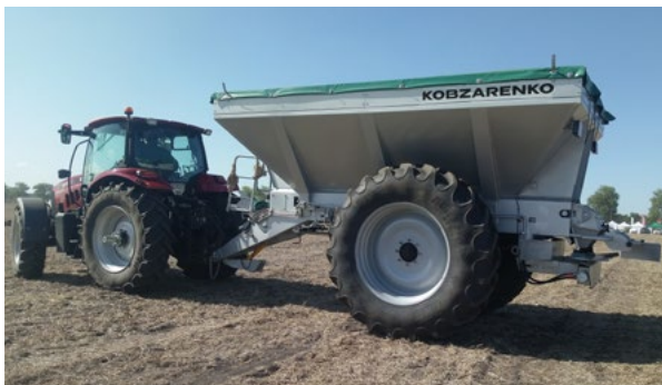
Mineraalväetise laotur töötab tehnoloogilise sõiduraja järgi
