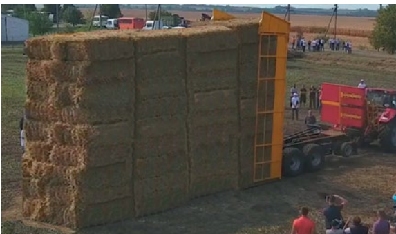
Pallide virnastamine ilma lisatehnikata
