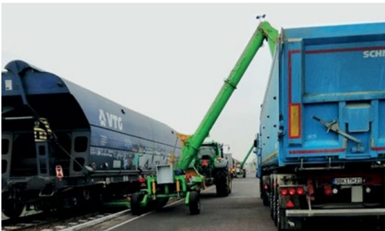
Vagunite tühjaks laadimine
