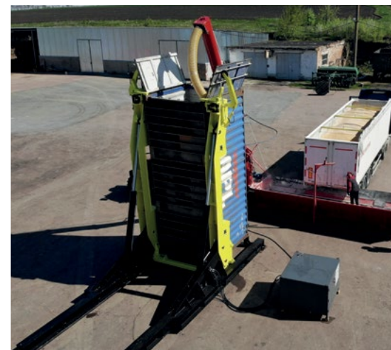
Ise eemaldab ja paigaldab konteineri otse konteineriveokilt
