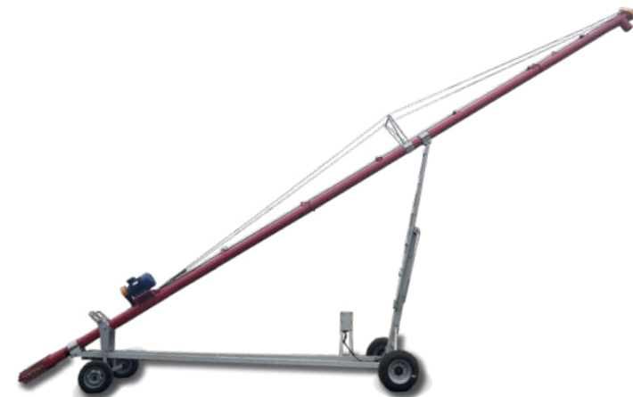
Statsionaarne tigu SH-200/15 laos ladestatud teravilja jaoks
