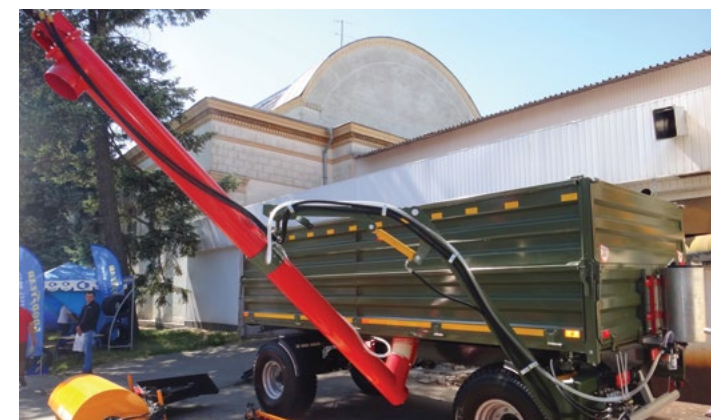
Külgaigaldatav kruvi NBŠ-250/4
