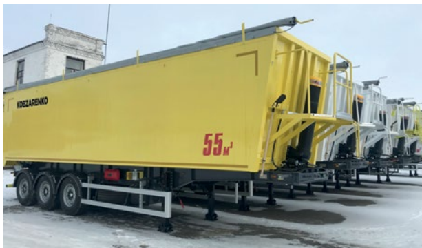
Alumiiniumist poolhaagis mudel 55, 90 m 3
