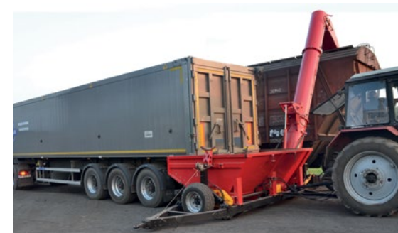
BNP-3 laadimisel, sõiduk paralleelselt vaguniga
