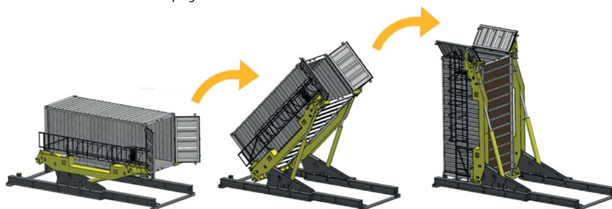
Konteineri kallutamise protsess
