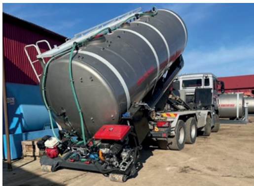
RZS paigaldamine veoauto šassiile
