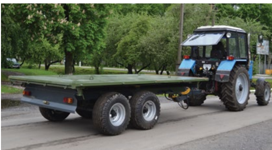
Kolmes suunas kallutatavad haagised on kergesti muudetavad tavalisteks platvormideks
