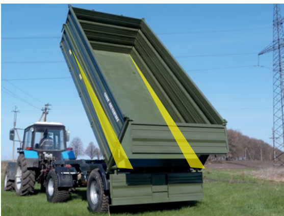
Kooniline kere – hoiab ära rohelise massi ja sõnniku kinnijäämise haagises
