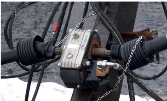
Autonoomne õlipump ZRM-180. Hüdmootori õlivoo suurendamiseks.
