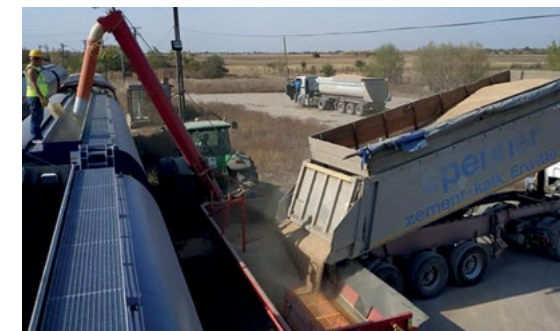
BNP-12 laadimisel, sõiduk risti vaguniga
