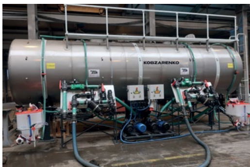
Statsionaarne segurjaam RZS-20 kahe sektsiooniga
