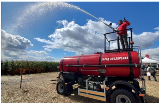
Tuletõrjemahuti PC-6. V - 6 m 3 Veevoolu kaugus kuni 30 m. Varustatud pumbaga (töötas traktori PTO-lt) või mootripumbaga (statsionaarne).
