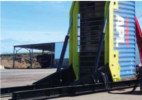
Посилені гідроциліндри для підняття/опускання
