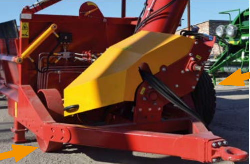
Додаткові передні колеса встановлені для транспортування зерна в бункері
