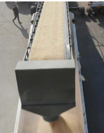
V-подібна шевронна стрічка 1 250 мм не пошкоджує насіння
