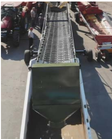
V-подібна шевронна стрічка 1 250 мм не пошкоджує насіння
