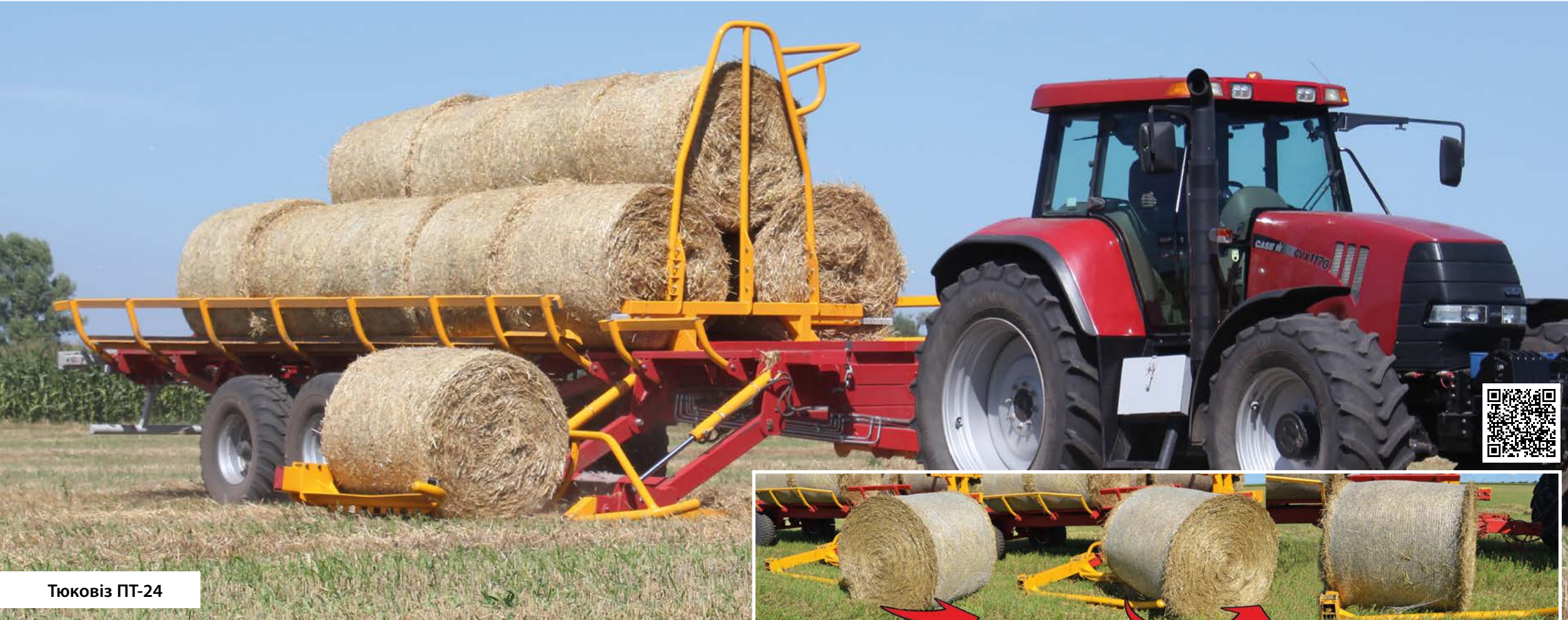
Універсальна гідравлічна лапа на ходу розвертає рулон та завантажує на платформу
