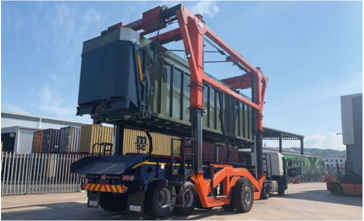
Кузов АЗП-60 встановлений на шасі
