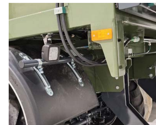
Бічні та задні світлодіодні ліхтарі для освітлення технологічної доріжки на полі
