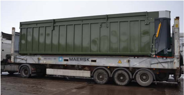
Кузов АЗП-60 для установки на контейнеровоз
