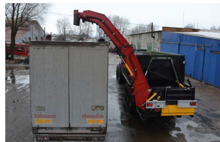
Перевантажувач буряків на висоту до 4,5 м.
