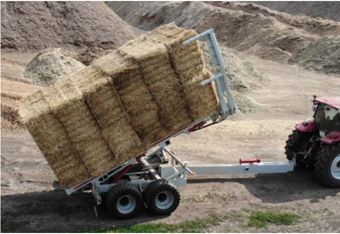
Розвантаження тюковозу на рівній і твердій поверхні займає 30-40 сек.
