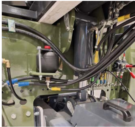
Дишло з гідравлічним регулюванням висоти трактора і гідрозаслінки з гідроаккумулятором.
