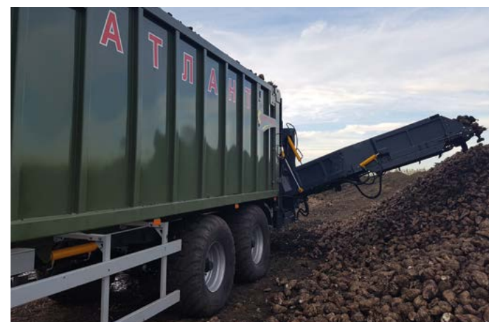
Кагатувальник буряків на висоту до 3,0 м.
