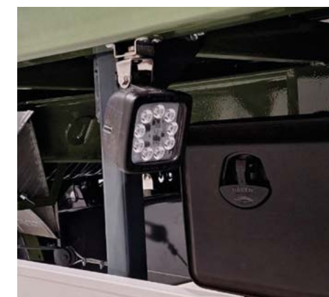
Бічні та задні світлодіодні ліхтарі для освітлення технологічної доріжки на полі
