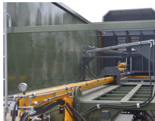
Гідравлічна система рухомої стінки
