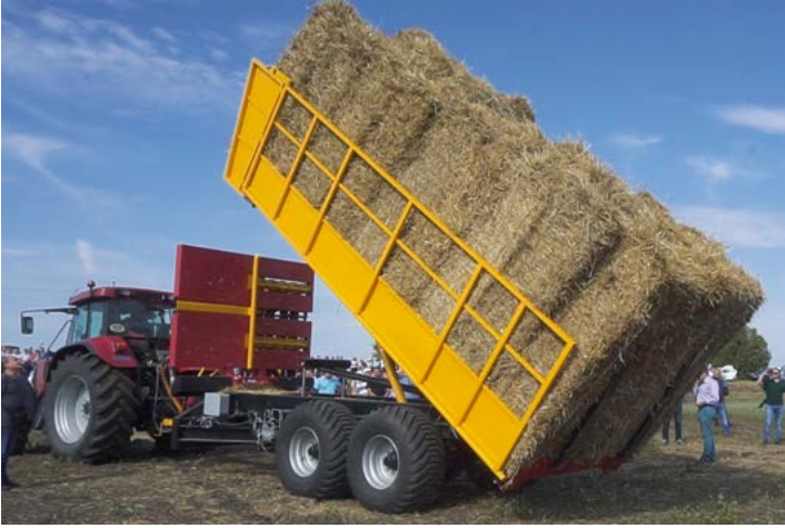
Розвантаження тюковоза на рівній і твердій поверхні займає 30-40 сек.
