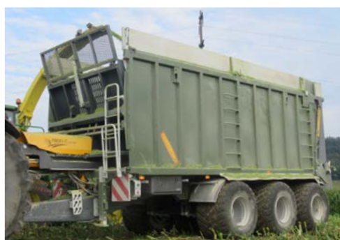
Hliníkové otevíratelné bočnice
