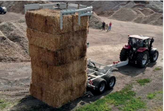
Vyložené balíky do stohu bez použití dalšího zařízení
