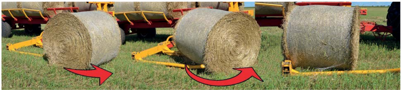
Univerzální hydraulické rameno se rozloží a nabere balík na korbu
