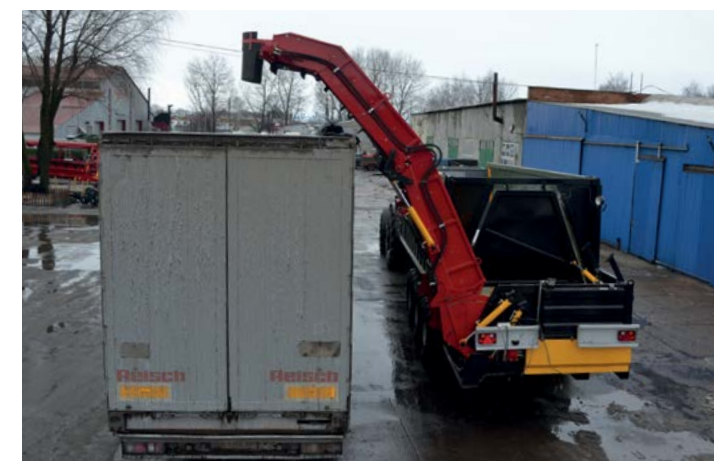
Překladač řepy do výšky 4,5m.
