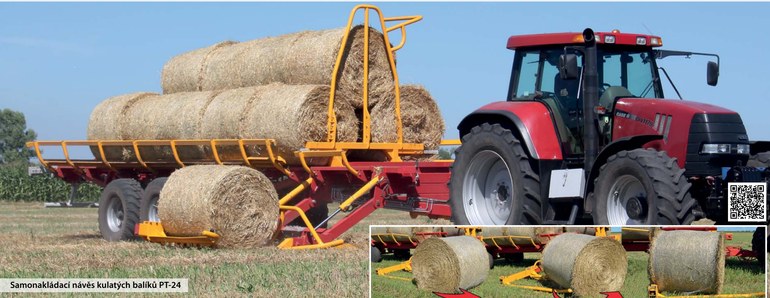
Univerzální hydraulické rameno se rozloží a nabere balík na korbu
