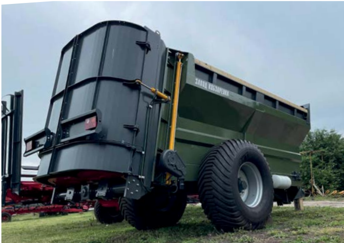
Zadní stěna se otevírá hydraulicky
