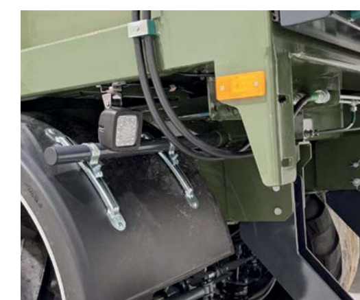
Boční a zadní LED světla pro osvětlení technologické dráhy
