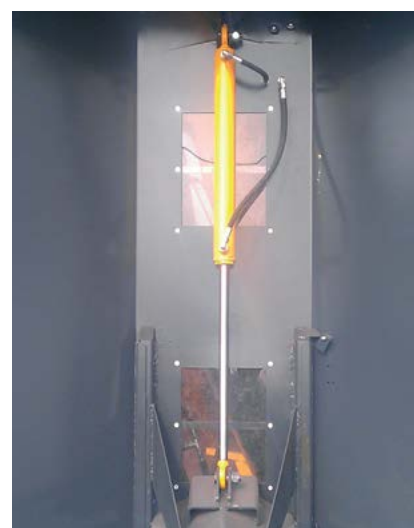
Hydraulická uzavírací klapka pro šnek na obilí
