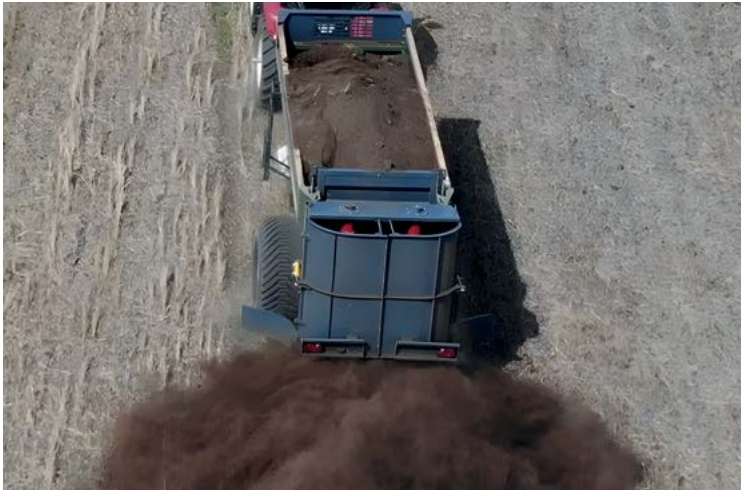
Aplikace organických hnojiv spodními talíři - minimální dávka
