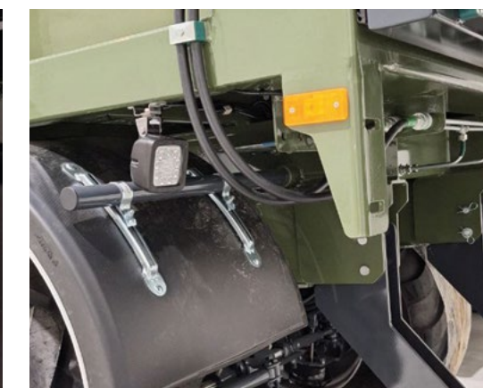
Бочна и задња ЛЕД светла за осветљавање технолошке стазе на терену
