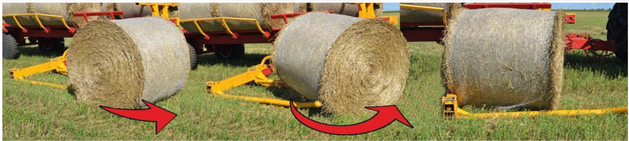
Универзална хидраулична шапа у покрету развија ролну и оптерећује платформу
