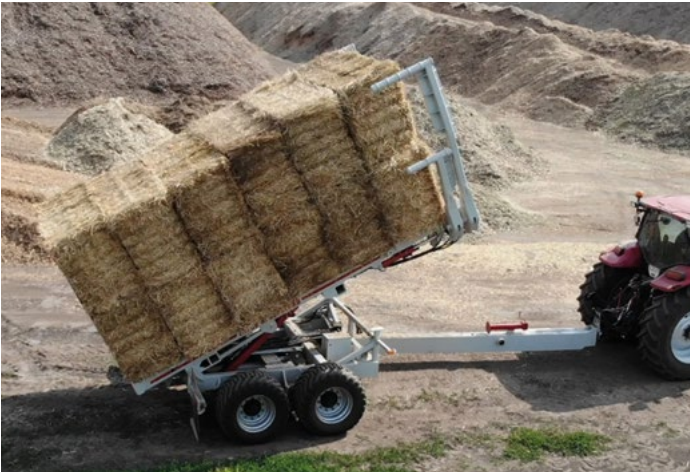
Истовар полуприколице за бале на равну и чврсту подлогу траје 30-40 секунди
