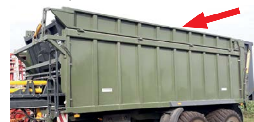
Option. Hayon latéral à ouverture hydraulique h-400 mm
