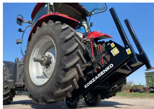
Chariot pour déplacer les roues du tracteur
