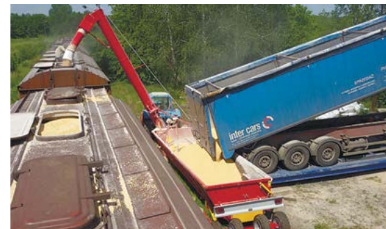
BNP-12 au chargement, benne perpendiculaire au wagon
