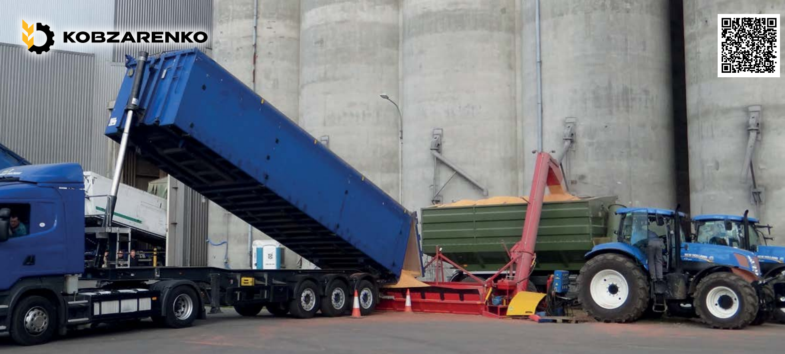
BNP-3 en cours de chargement, benne parallèle au wagon
