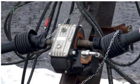
Centrale hydraulique sur ZRM-180. Pour augmenter le débit d'huile sur le moteur hydraulique.
