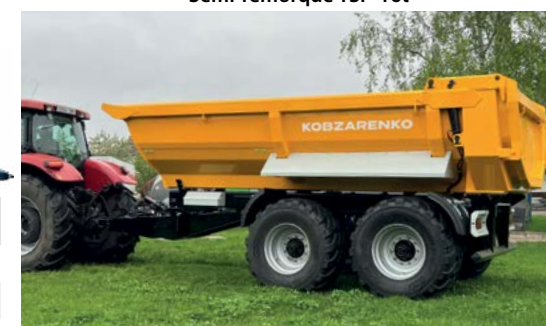
Semi-remorque TP mod.TSP-12b en acier Hardox
