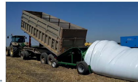
ZPM(A) -180 avec trémie abaissée et moteur électrique. Chargement depuis un véhicule.
