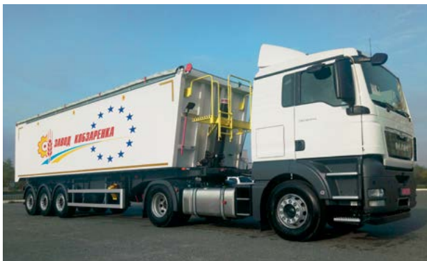
Semi-remorque PL en aluminium. Modèle 55, 90 m 3
