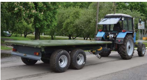
Remorques à déchargement trilatéral se transforment facilement en plateau ordinaire
