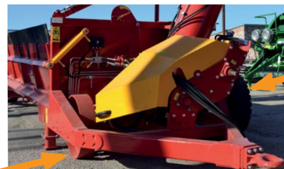
Des roues avant supplémentaires sont montées pour les travaux d'emballage
