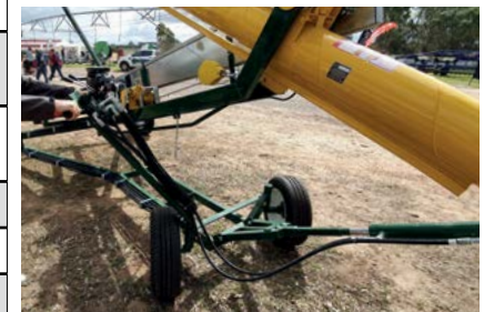
En option: mécanisme de direction des roues postérieures
