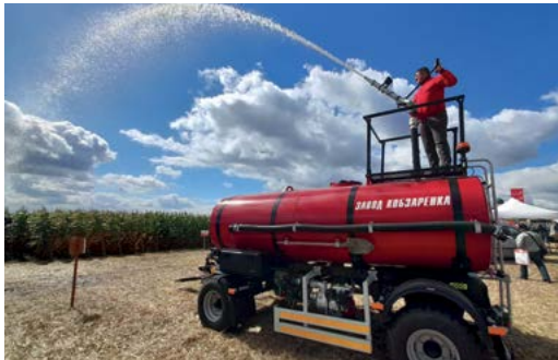
Réservoir d'incendie PC-6. V - 6 m 3
