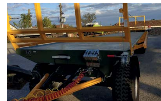
Extension de la plate-forme jusqu'à 3 m
