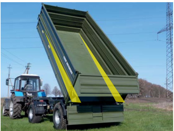
Corps conique : exclue la suspension de la matière verte et du fumier dans la remorque
