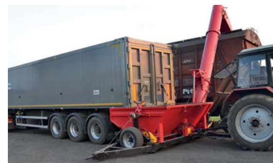
BNP-3 en cours de chargement, benne parallèle au wagon
