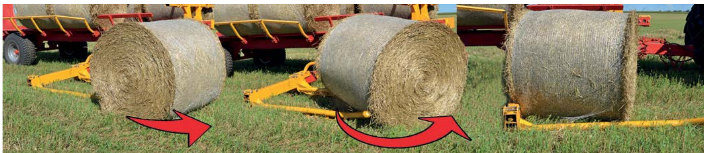
La dent hydraulique universelle en mouvement déplie la balle et la charge sur la plate-forme.
