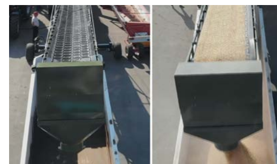
Le tapis à chevrons en forme de V 1200 mm. n'abîme pas les semences
