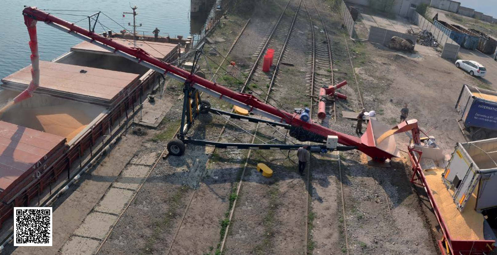
SN-350/22 lors du chargement des céréales dans l'entrepôt 3 tonnes/m 2
