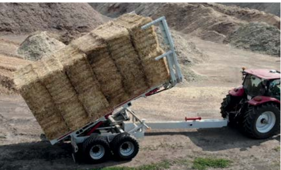
Le déchargement de l'autochargeuse sur un sol de niveau et dur prend 30 à 40 secondes.
