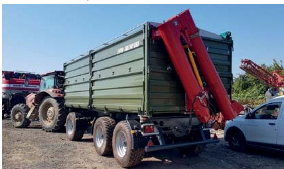
Le hayon est adapté à la vis de rechargement.
