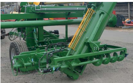
Vis sans fin horizontale auxiliaire pour l'égrenage du maïs
