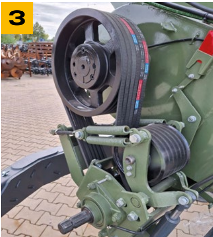
ОДВОЖЕНИ ПОГОН СА НАИЗМЕНИЧНИМ УКЉУЧИВАЊЕМ ПУЖА
