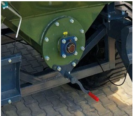
ВИЈЧАНИ МЕХАНИЗАМ ОТВАРАЊА ХОРИЗОНТАЛНОГ ПОКЛОПЦА ЗА ЧИШЋЕЊЕ ПУЖА
