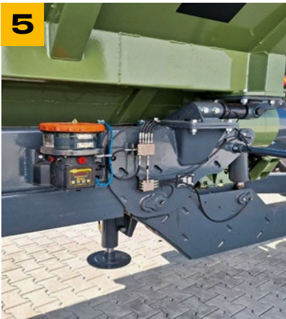
ПРОГРАМАБИЛНИ РАЧУНАР СА ПРЕЦИЗНИМ ИНТЕРВАЛОМ ПОДМАЗИВАЊА ЛЕЖАЈЕВА
