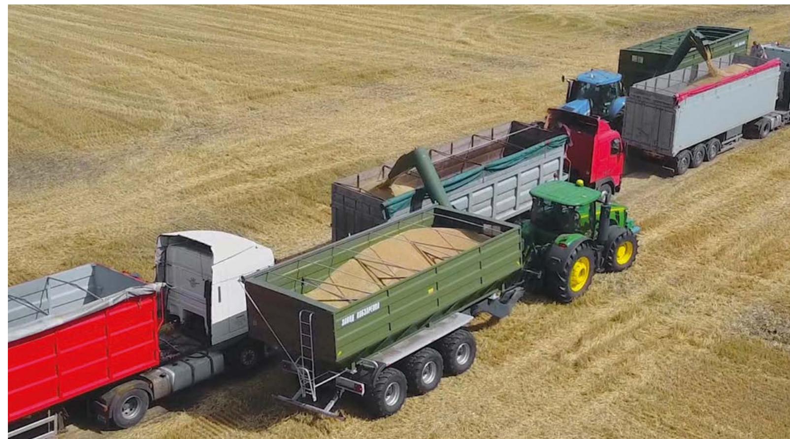
Подовжений шнек висотою 5,5 м для завантаження у вагони
