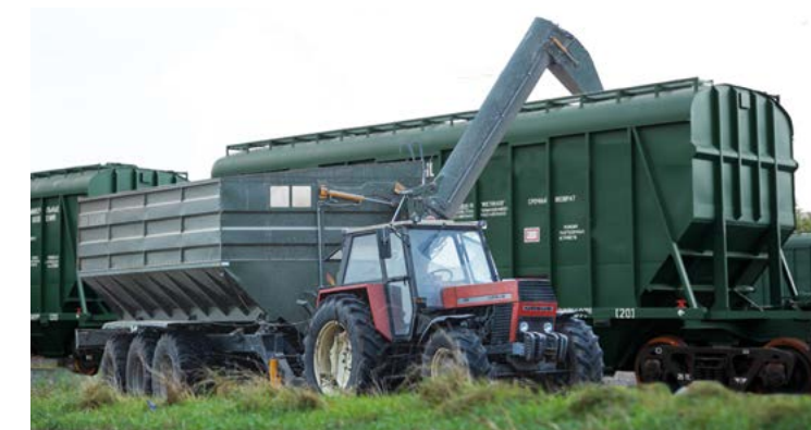
Подовжений шнек висотою 5,5 м для завантаження у вагони
