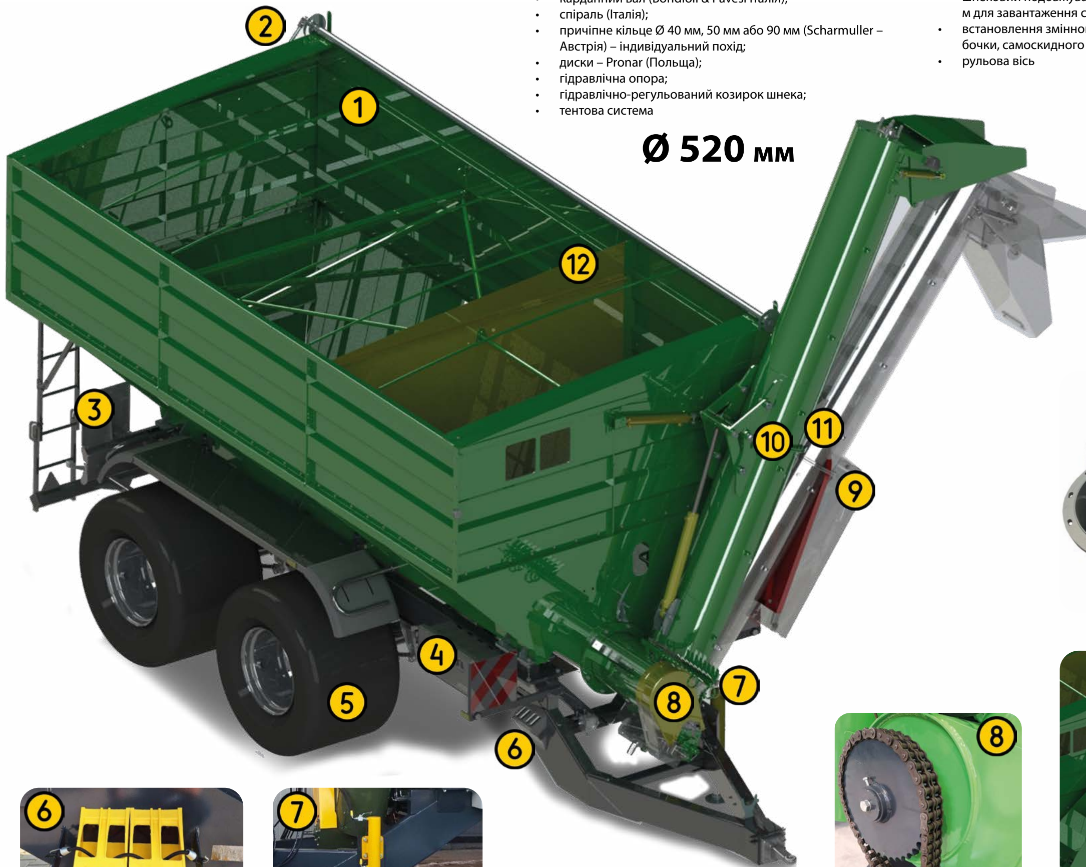
Боки кузова стягнуті потужними профільними проставками
