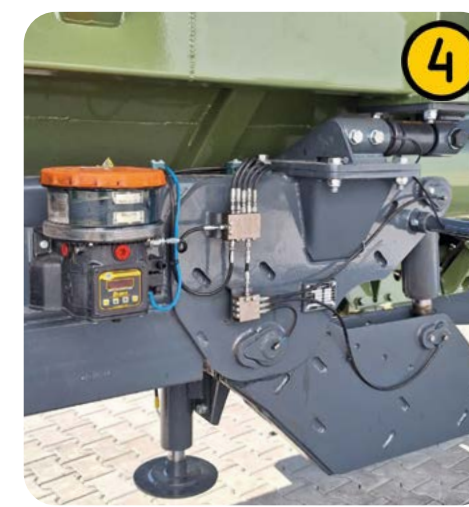
Програмований комп'ютер з точним інтервалом мастила підшипників
