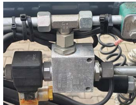
Гідравлічний клапан для блокування відкриття шиберної заслінки при фіксованому ВВП трактора.
