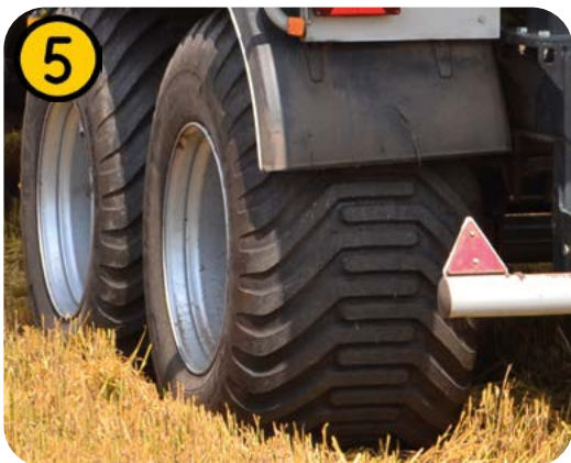
Максимальний розмір колеса 850/40R26,5 - Мінімальний тиск на ґрунт 1,5 кг/см 2
