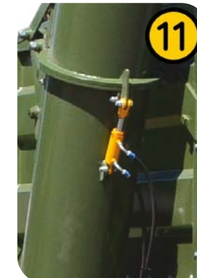
Гідравлічний замок двох частин шнека
