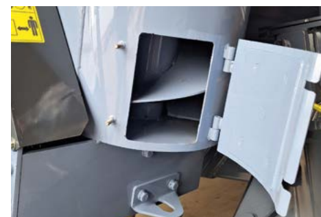
Один люк для очищення вертикального шнека
