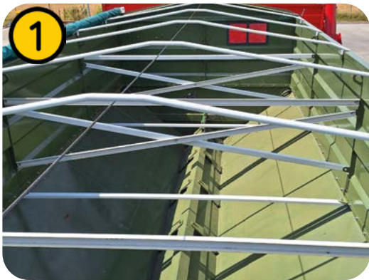
Боки кузова стягнуті потужними профільними проставками
