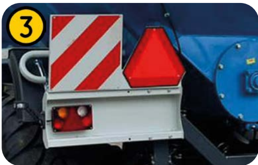
Дорожнє освітлення причепа за стандартами ЄС
