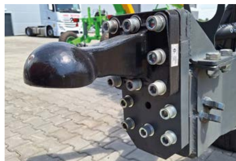
Адаптер для регулировки высоты для присоединения к любому трактору.
