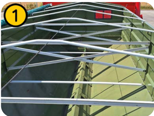
Бока кузова стянуты мощными профильными проставками
