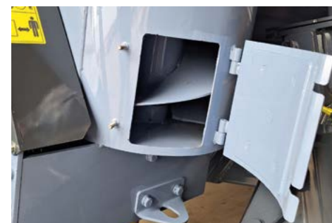
Один люк для очистки вертикального шнека
