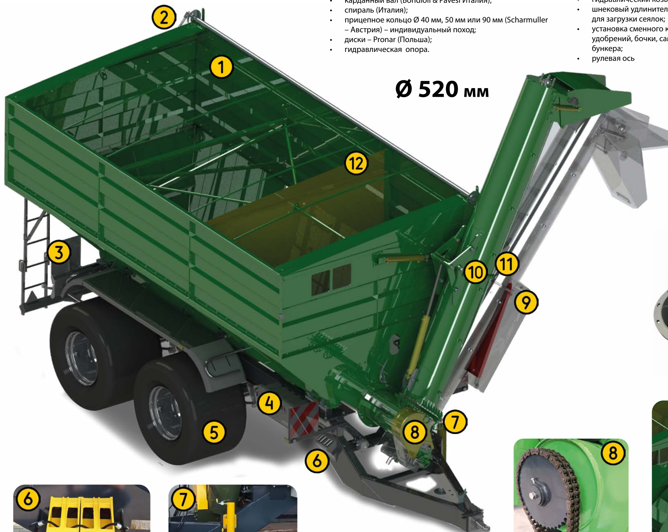
Бока кузова стянуты мощными профильными проставками
