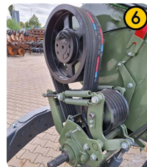
Раздельный привод с поочередным включением шнеков. Привод вертикального шнека осуществляется непосредственно через редуктор, горизонтального шнека - через ременную передачу.
