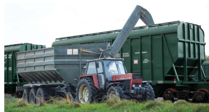
Удлинённый шнек высотой 5,5 м для загрузки в вагоны
