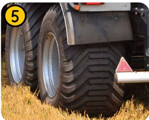
Максимальный размер колеса 850/40R26,5 - Минимальное давление на грунт 1,5 кг/см 2
