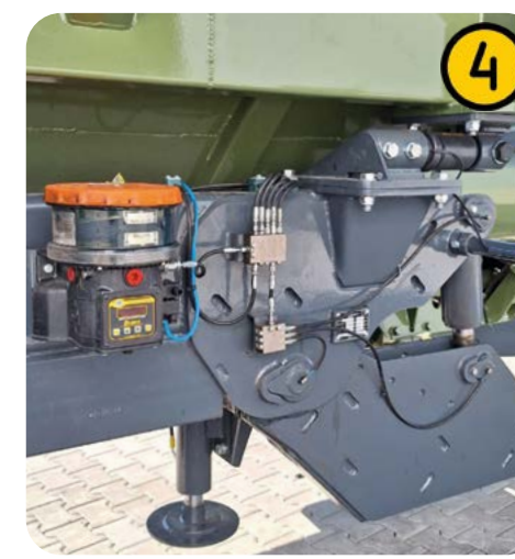
Программируемый компьютер с точным интервалом смазки подшипников
