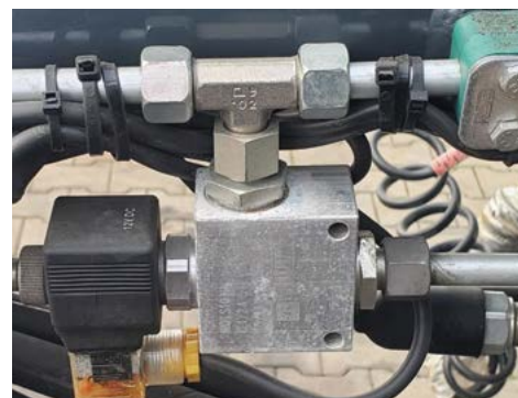
Гидравлический клапан для блокировки открытия шиберной заслонки при фиксированном BOM трактора.
