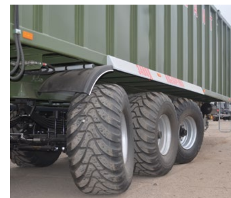
Esimene ja kolmas juhitud teljed
