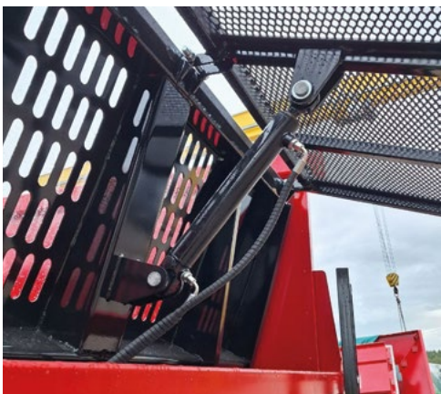
Hüdrauliliselt avatav võrk liigutataval seinapaneelil
