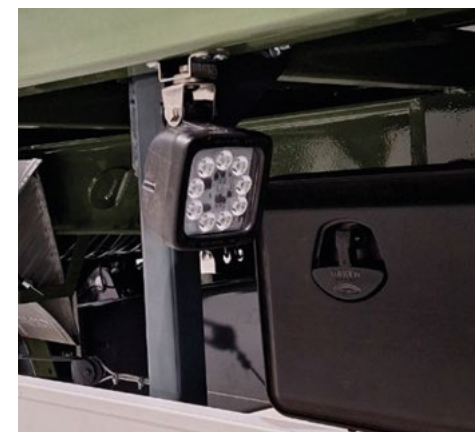
Külj- ja tagumised LED-tuled tehnoloogilise tee valgustamiseks põllul
