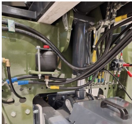
Haakekonks koos traktori kõrguse hüdraulilise reguleerimise ja hüdroklapiga, millel on hüdroaku.
