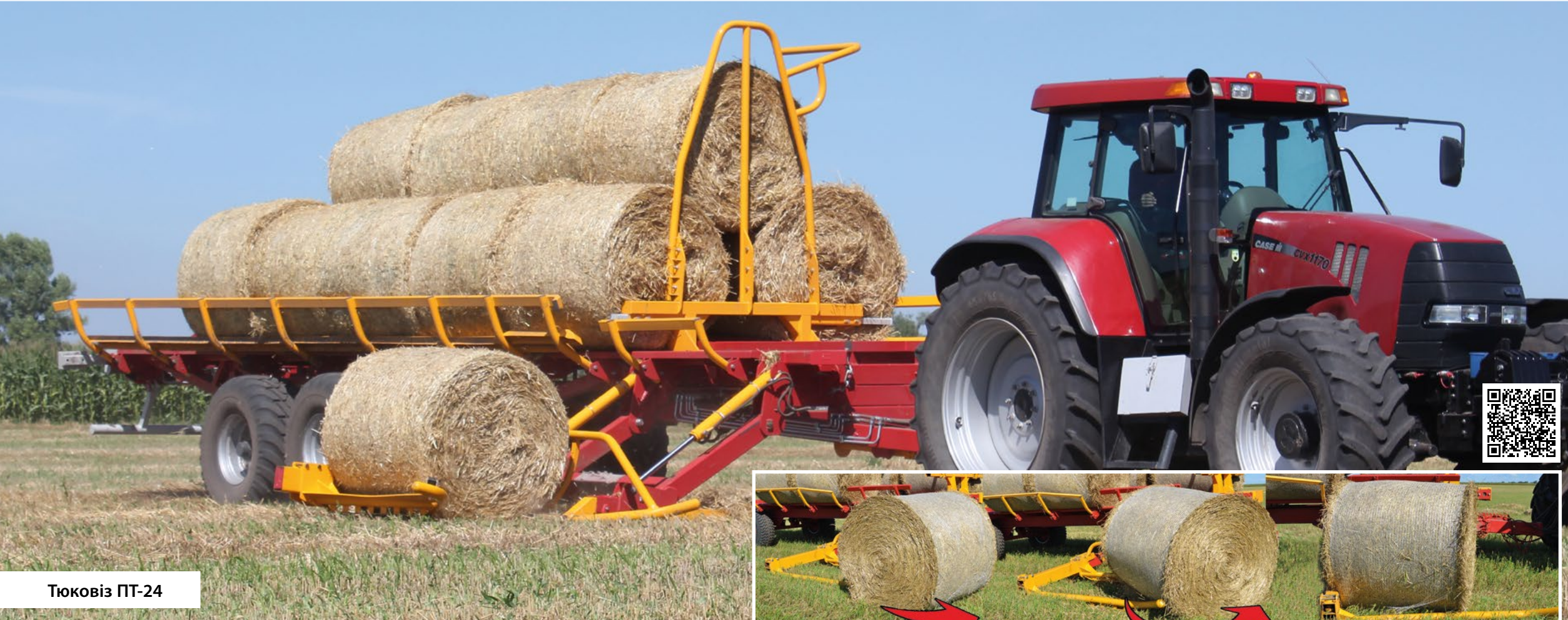
Universaalne hüdrauliline käpp keerab palli ja laeb selle platvormile
