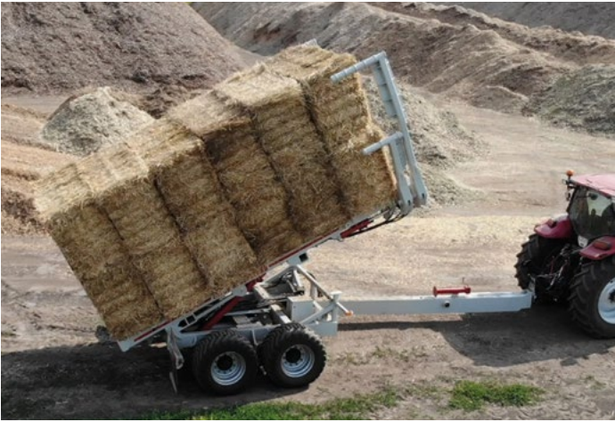
Iselaadiva poolhaagise mahalaadimine tasasel ja kindlal pinnal võtab 30-40 sekundit
