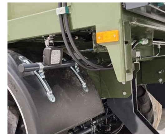
Külj- ja tagumised LED-tuled tehnoloogilise tee valgustamiseks põllul
