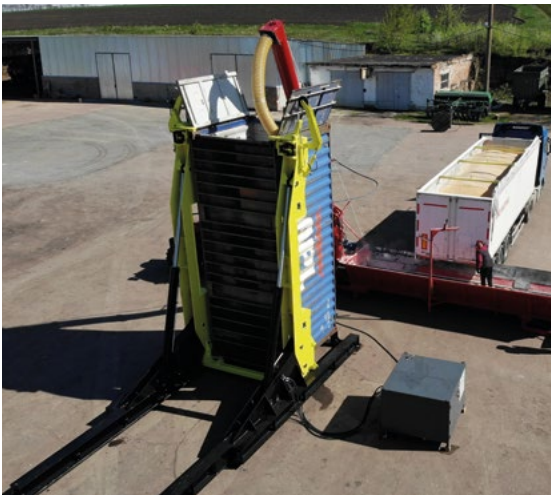
Самостоятельно снимает и устанавливает контейнер непосредственно с контейнеровоза.
