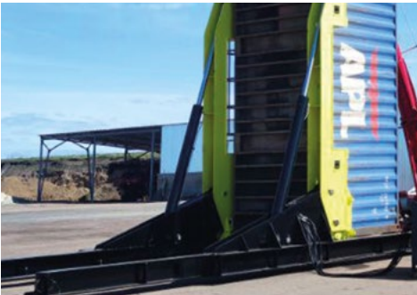
Усиленные гидроцилиндры для поднятия/опускания
