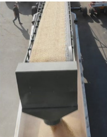
V-образная шевронная лента 1250 мм не повреждает семян.
