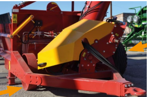
Дополнительные передние колеса установлены для транспортировки зерна в бункере.
