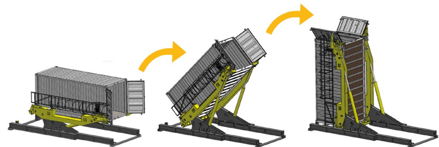
Процес на обръщане на контейнера
