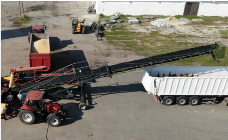
La lunghezza del trasportatore è di 22 m.
