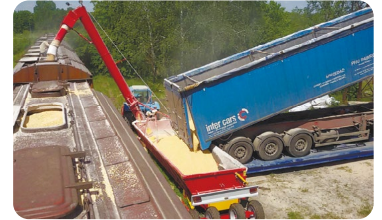
BNP-12 "KOVCHEG" - CARICO DI VAGONI A TRAMOGGIA
