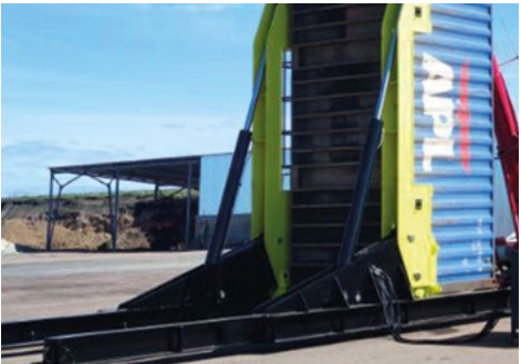
Cilindri idraulici rinforzati per sollevamento/ abbassamento
