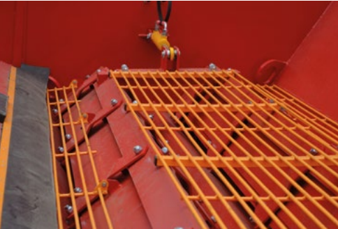
Cancello scorrevole ad apertura idraulica. Fornisce il grano a un trasportatore a coclea.
