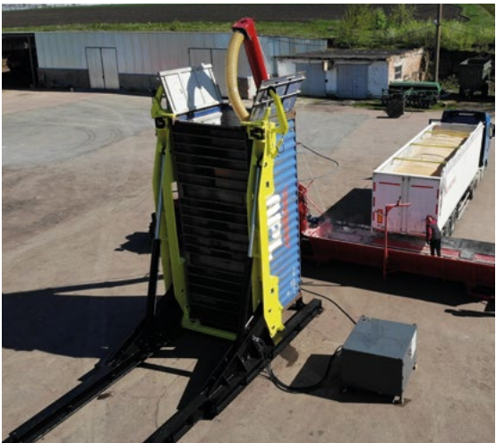
Rimuove e installa in modo indipendente il container direttamente dalla nave portacontainer
