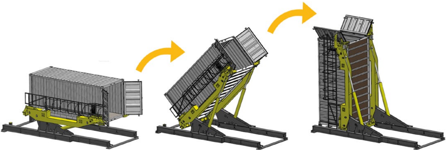
Processo di ribaltamento dei contenitori
