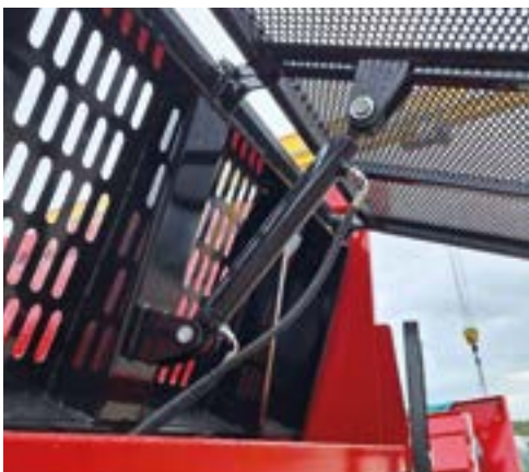
Plasa cu deschidere hidraulică pe un perete glisant
