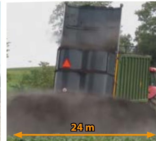
Defecare răspândit cu farfurii. Hayon închis
