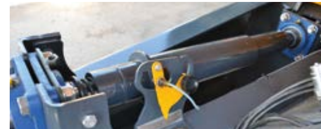
Un regulator de sarcină de torsiune, care la sarcinile de vârf oprește debitul către bătăi de împrăștiere, blocând alimentarea cu ulei către cilindrul hidraulic
