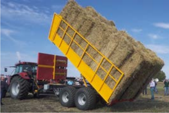
Descărcarea semiremorcii cu baloti pe o suprafață solidă durează 30-40 de secunde
