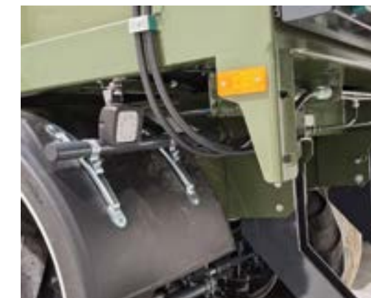
Lumini LED laterale și din spate pentru a ilumina pista tehnologică de pe teren
