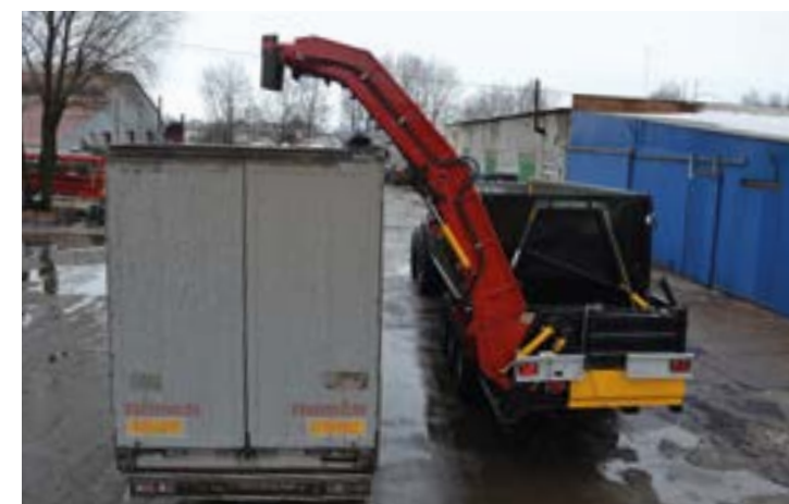
Reincarcator de sfecla pana la o inaltime de 4,5 m.
