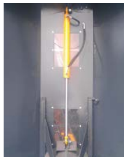
Inchidere hidraulică ap pentru melcul cerealelor
