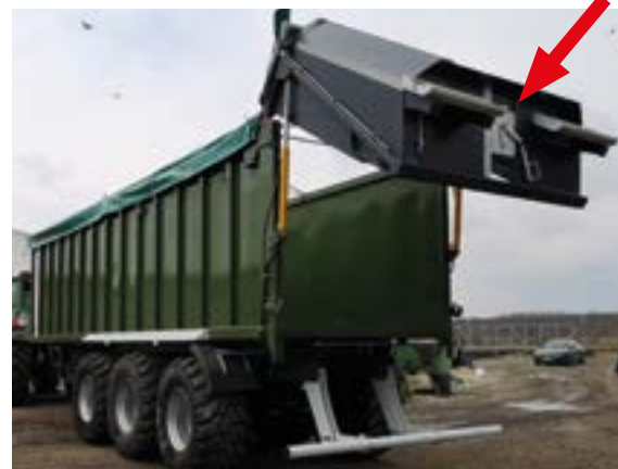
Supapă spate pentru descărcarea cerealelor
