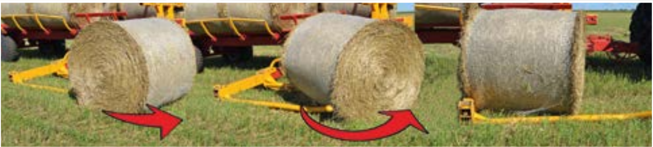
BRAT hidraulic universal ,din mers se deschide și încarcă balotul pe platformă
