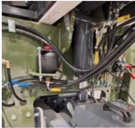
Bara de remorcare cu reglare hidraulică pe înălțime tractor și un amortizor hidraulic cu acumulator hidraulic
