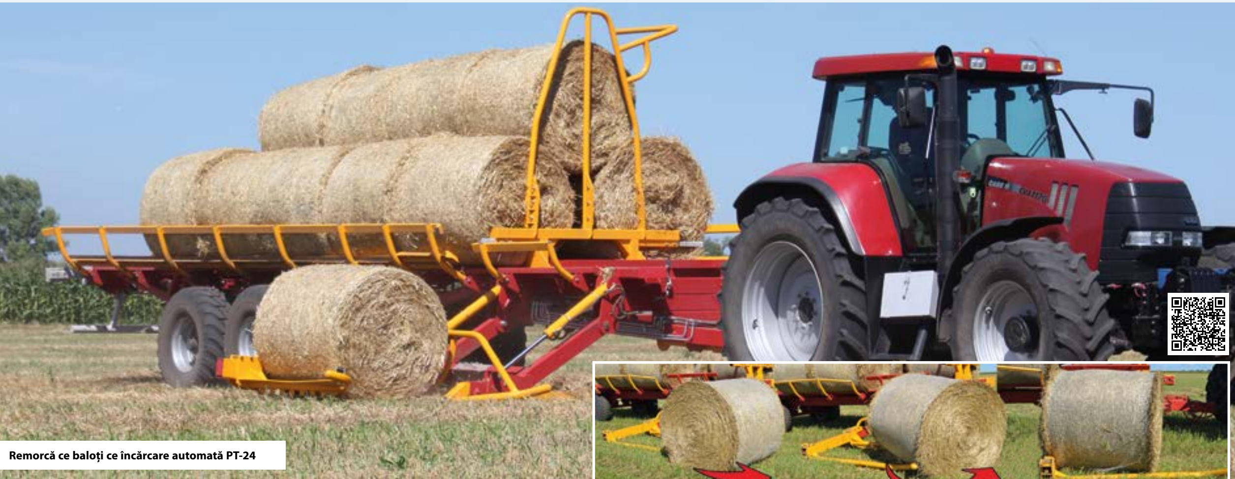
BRAT hidraulic universal ,din mers se deschide și încarcă balotul pe platformă
