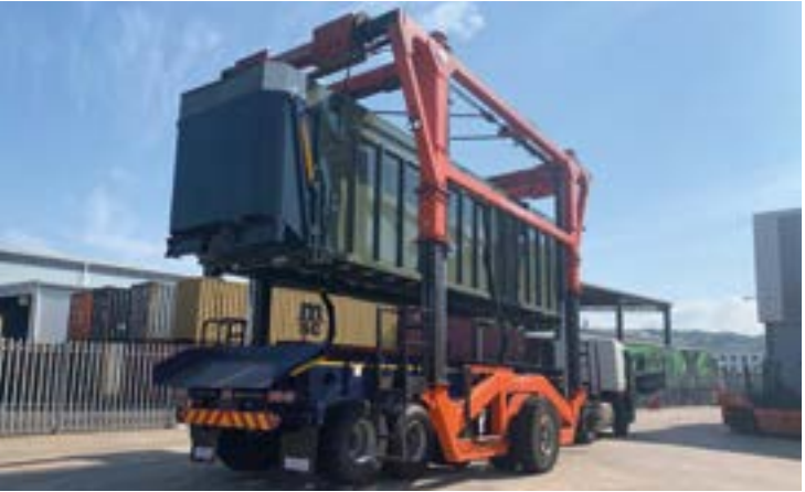
Caroseria AZP-60 montată pe șasiu
