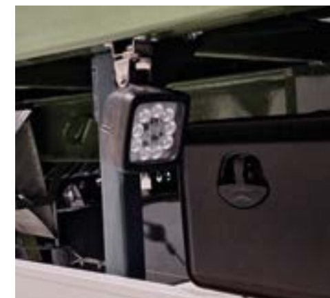
Lumini LED laterale și din spate pentru a ilumina pista tehnologică de pe teren
