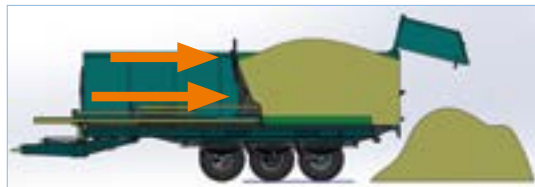
Jumătate din partea de jos se mișcă cu peretele frontal
