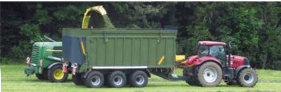
Jumătate din partea de jos se mișcă cu peretele frontal
