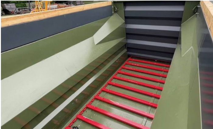
1.3 m wide apron conveyor.
