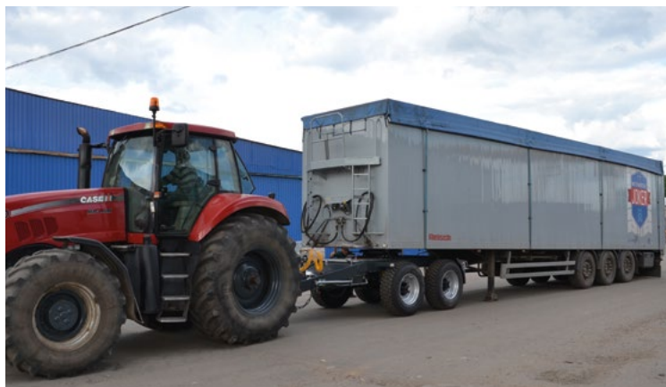
Веза ПСП-20 Долли са камионском полуприколицом и тегљачем
