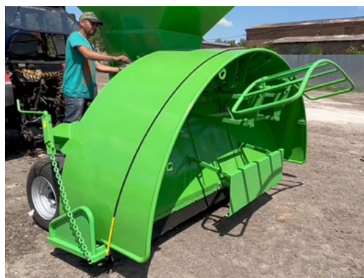
Повдигане/спускане на рамката, върху която лежи ръкавът - с лебедка
