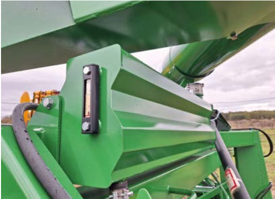
Dodatkowy zbiornik oleju z termometrem
