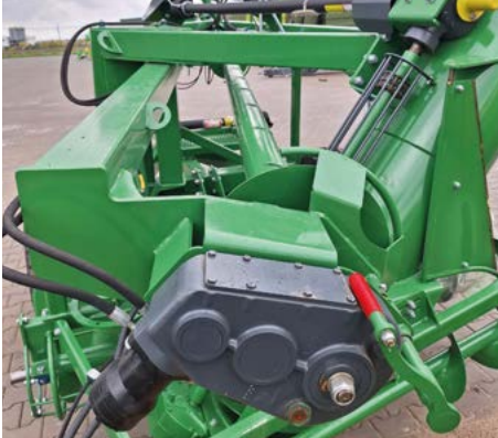
Mechanizm nawijania i zdejmowania worka
