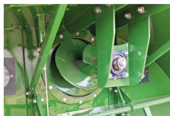
Ślimak ze wzmocnioną krawędzią
