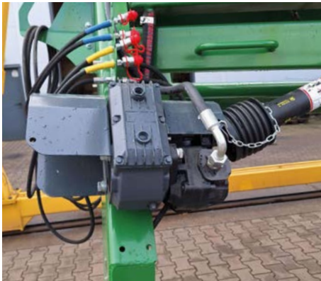
Autonomiczna stacja hydrauliczna zwiększająca przepływ oleju w silniku hydraulicznym
