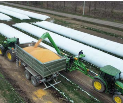
Wysokość rozładunku z rękawów wynosi 4,3 m
