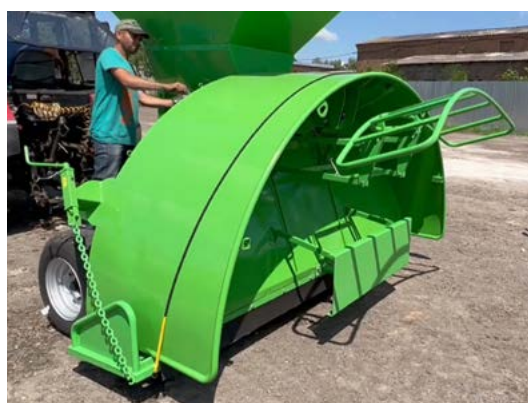
Podnoszenie/opuszczanie ramy, na której leży rękaw foliowy- za pomocą wciągarki
