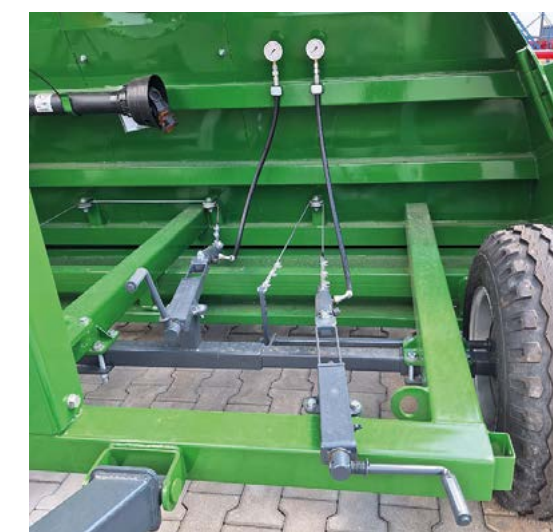
Regulacja ciśnienia w układzie hamulcowym dla każdego koła z osobna
