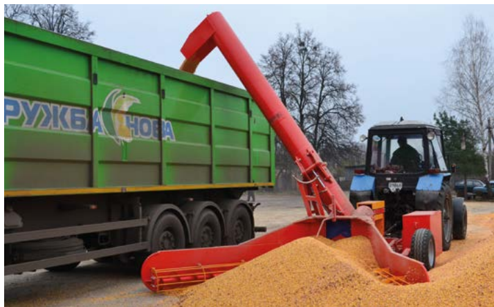
Grūdų perkrovimas į NRU-180
