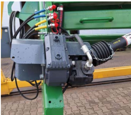
Autonominė tepalo sistema ant ZRM-180. Užtikrina tolygų tepalo padavimą į hidrovarklius
