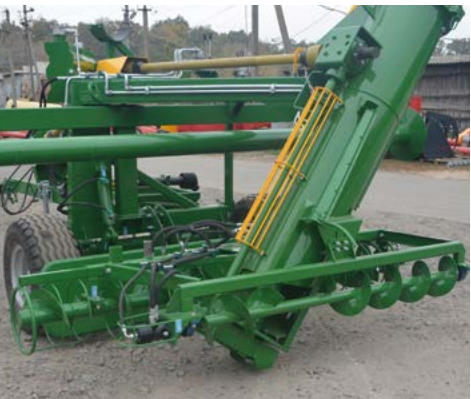
Papildomas horizontalus staigtas, skirtas kukurūzo išėmimui
