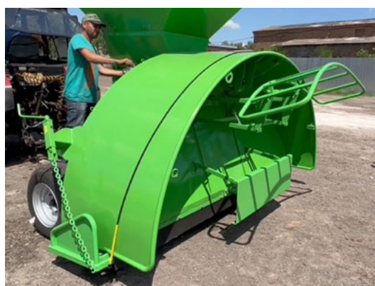
Zvedání/spouštění rámu, na kterém leží skříň – navijákem
