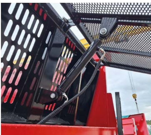
Hydraulicznie uchylna kratka na ścianie przesuwnej
