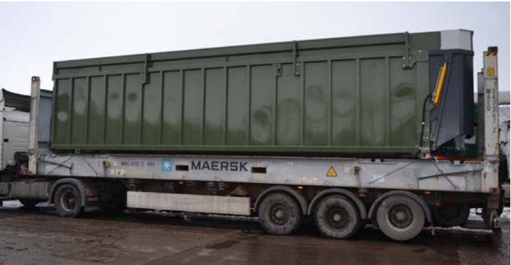
Kontener AZP 60 do montażu na podwoziu kontenerowym
