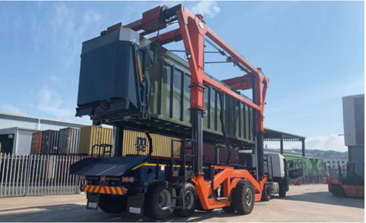
AZP-60 montowany na podwoziu kontenerowym
