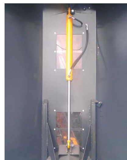
System hydraulicznego zamykania zsyphu
