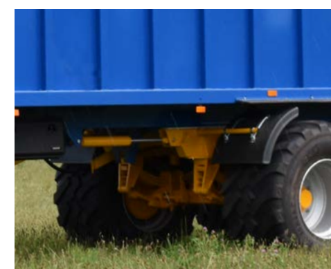
Hydraulicznie przesuwane podwozie
