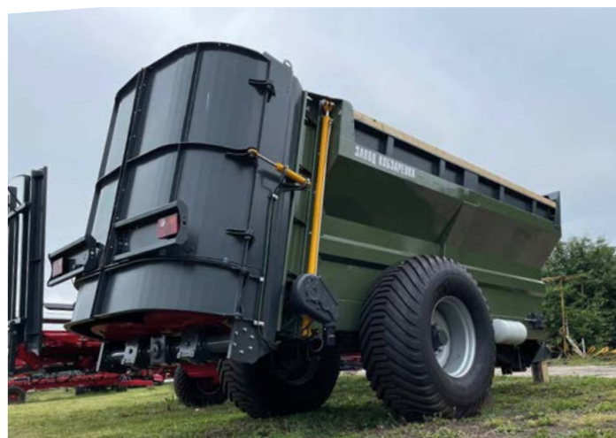
Dwuskrzydłowa tylna przesłona otwierana hydraulicznie, osobno w lewo i osobno w prawo
