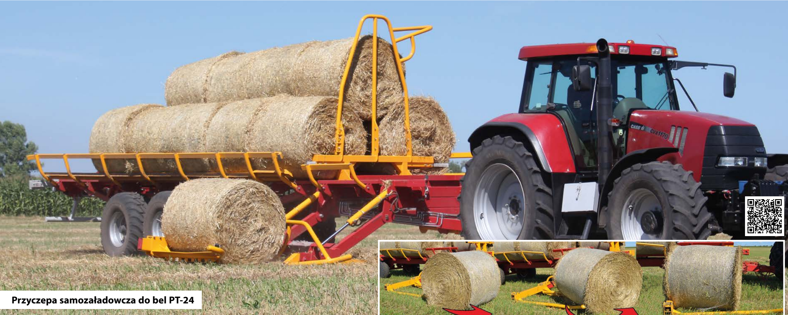
Uniwersalny hydrauliczny chwytak do bel w ruchu rozkłada rolkę i ładuje na platformę
