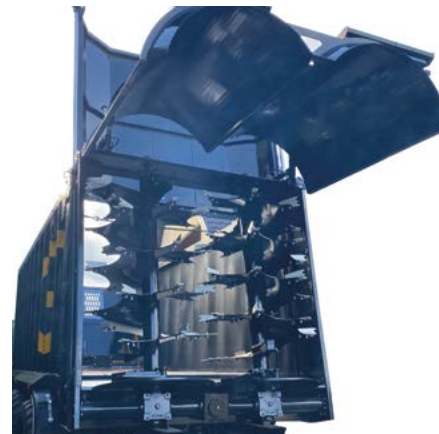
Adapter do rozrzutu nawozów organicznych, obornika oraz wapna Grazioli
