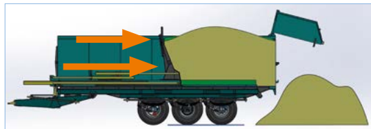
Przesuw ściany wraz z połową podłogi
