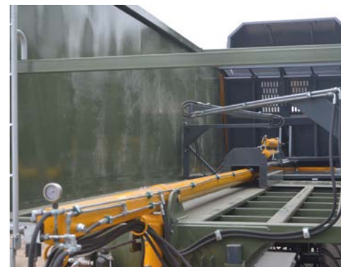
System hydraulicznego przesuwu ściany
