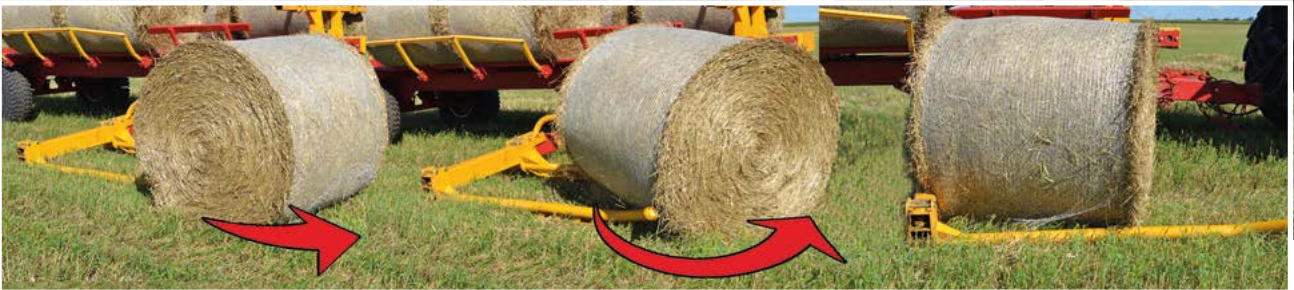
Uniwersalny hydrauliczny chwytak do bel w ruchu rozkłada rolkę i ładuje na platformę
