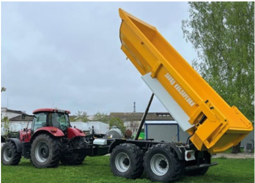
Teleskopowy siłownik hydrauliczny DiNatale (Włochy)
