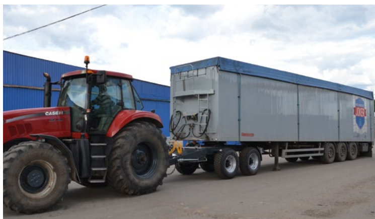
Połączenie wózka PSP-20 z naczepą samochodu ciężarowego i ciągnikiem rolniczym
