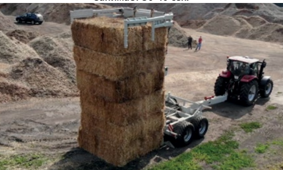
Скирдование тюков без привлечения дополнительной техники
