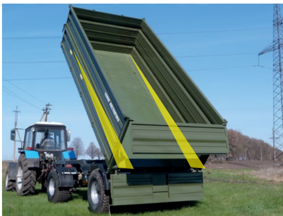
Конический кузов – исключает зависание, зеленой массы и навоза в прицепе
