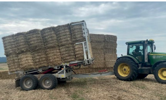
Разгрузка тюковоза на ровной и твердой поверхности занимает 30-40 сек.
