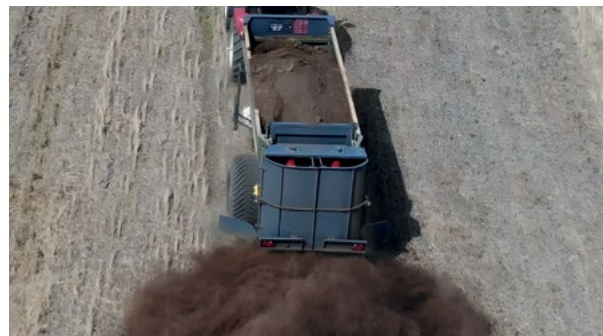
Внесение органических удобрений нижними пластинами – минимальная норма
