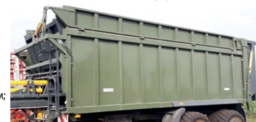
Опция. Боковой гидравлически-открывающийся борт h-400 мм
