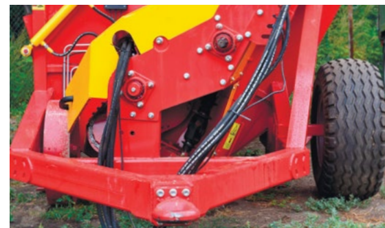
Дополнительные передние колеса установлены для упаковочных работ
