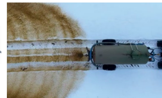
Эжекторный распределитель, внесение по снегу
