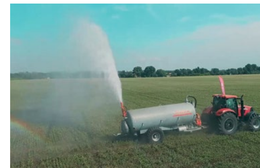
Гидро пушка для полива и поверхностного внесения удобрений, тушения пожаров
