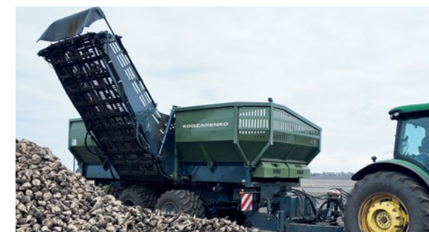
Разгрузка свеклы на высоту до 4,8 м.
