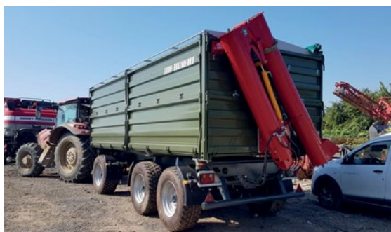
Задний борт адаптирован для перегрузочного шнека
