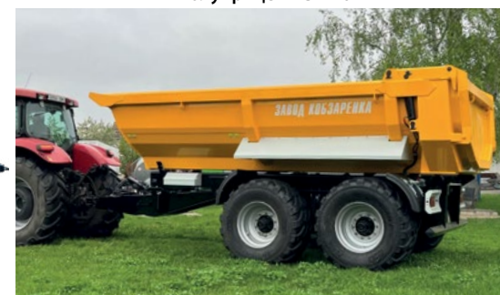
Полуприцеп ТСП-126 строительный из стали Hardox
