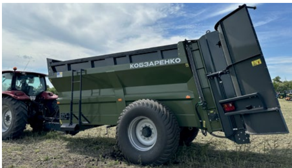
Задняя стенка открывается гидравлически
