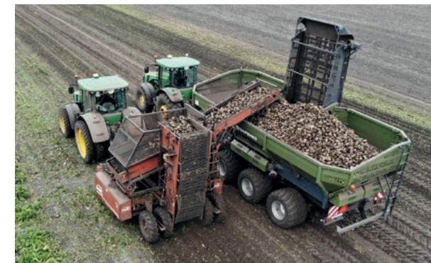
Колеса 800/45 R26.5 снижают давление на почву
