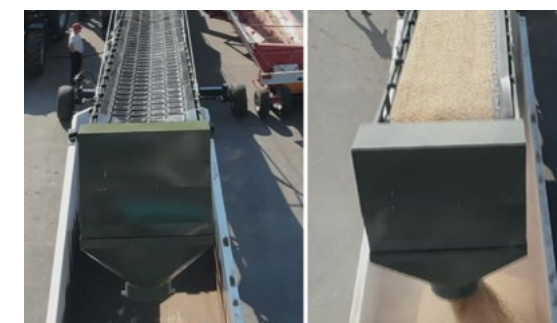
V-образная шевронная лента 1200 мм. не повреждает семена
