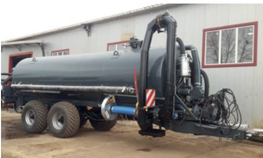
Антикоррозионное покрытие полимерными красками, гидравлический смеситель
