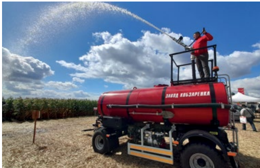
Пожарная цистерна ПЦ-6. V - 6 м³ Дальность потока воды на расстоянии до 30 м. Комплектация насосом (работает от ВОМ трактора) или мотопомпой (работает стационарно)
