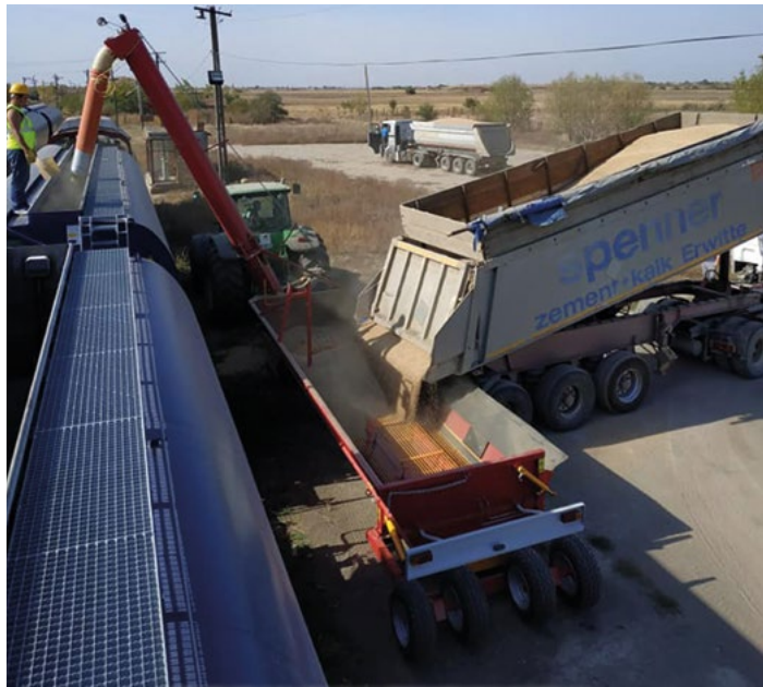
БНП-12 НА ЗАВАНТАЖЕННІ ЗЕРНА, АВТОМОБІЛЬ ПЕРПЕНДИКУЛЯРНО ДО ВАГОНУ
