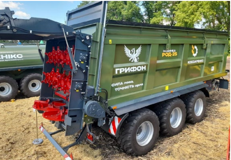
2 ГОРИЗОНТАЛЬНІ БІТЕРИ + 2 РОЗКИДАЛЬНІ ДИСКИ. ШИРИНА ВНЕСЕННЯ ДО 12 М.
