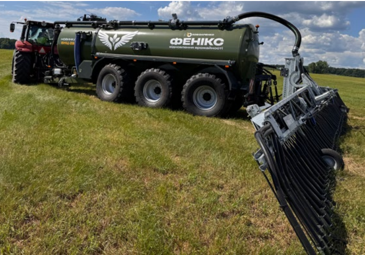
КОЛЕСА 750/60 R30.5 ІЗ ПРОТЕКТОРОМ FL630 SUPER
