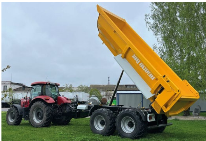
НАПІВПРИЧЕП ТСП-12 БУДІВЕЛЬНИЙ ЗІ СТАЛІ HARDOX 6 MM. ВАНТАЖОПІДЙОМНІСТЬ 19,3 Т. - ДЛЯ ПЕРЕВЕЗЕННЯ НАДВАЖКИХ ВАНТАЖІВ
