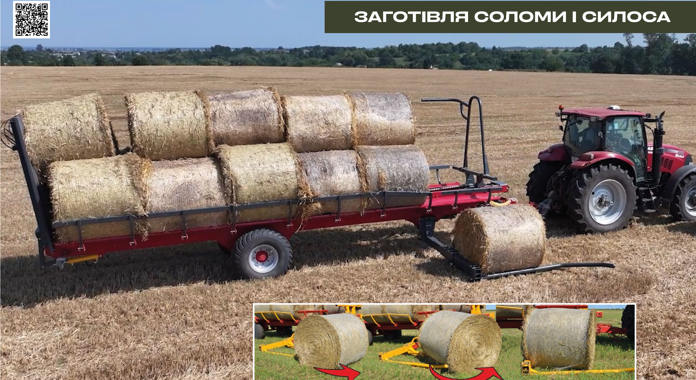
Універсальна гідравлічна лапа на ходу розвертає рулон та завантажує на платформу
