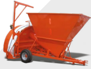
ЗПМ-180п понижений приймальний (бункер)
