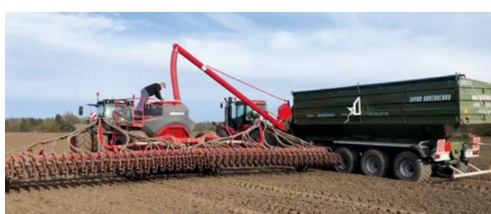
ШНЕК-ПОДОВЖУВАЧ ШРП-5 ДЛЯ ЗАВАНТАЖЕННЯ СІВАЛОК ТА РОЗКИДАЧІВ МІНДОБРІВ
