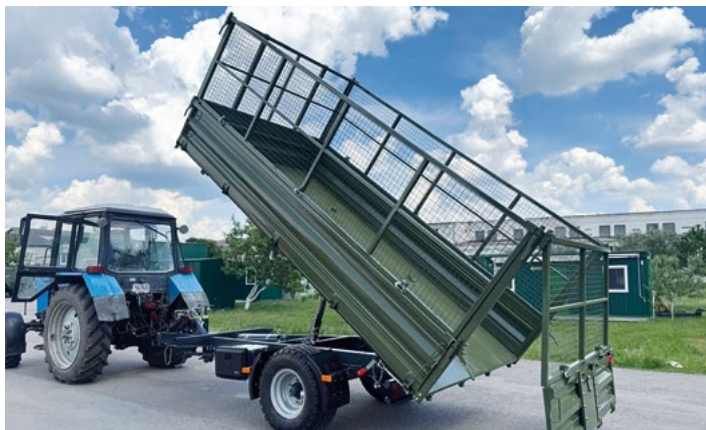
НАПІВПРИЧЕП ТСП-6Т З СІТКОЮ ДЛЯ ОБ'ЄМНИХ ВАНТАЖІВ
