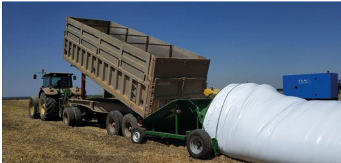
ЗПМ(А)-180 з пониженим бункером та електродвигуном. Завантаження від автомобіля.
