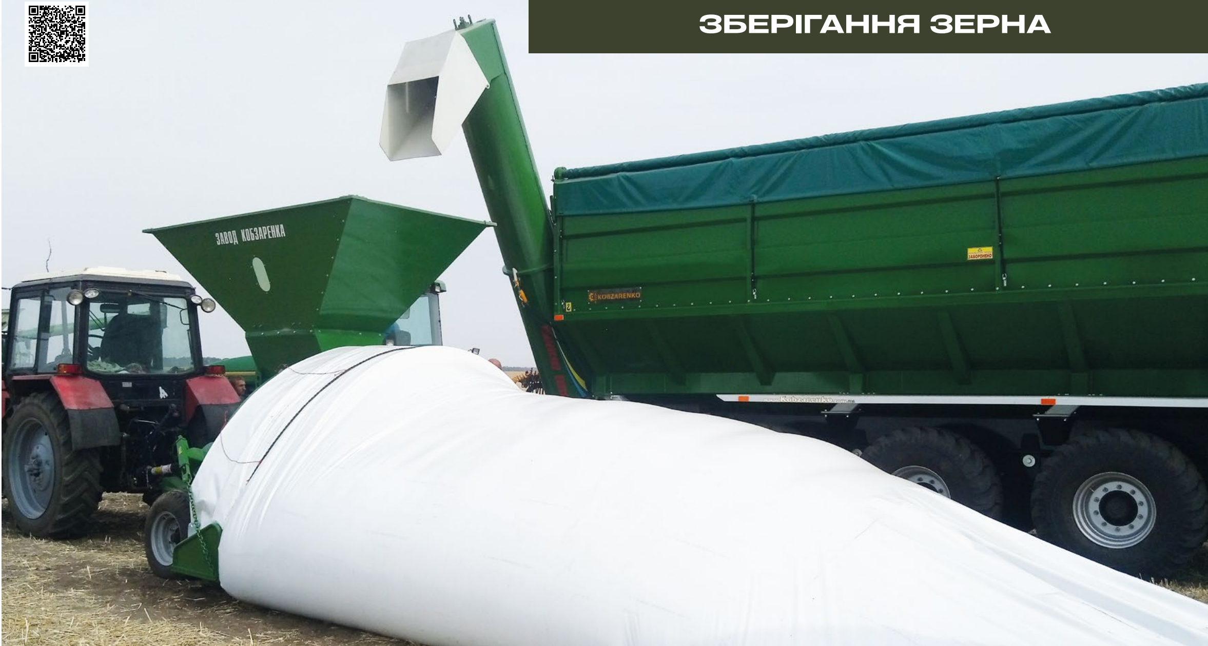
ЗПМ(А)-180 з пониженим бункером та електродвигуном. Завантаження від автомобіля.
