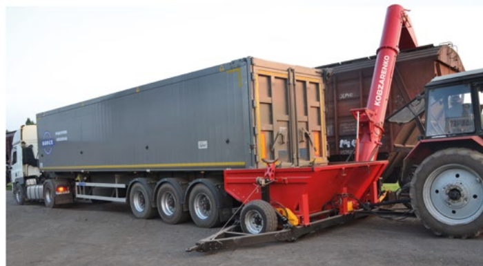
БНП-3 НА ЗАВАНТАЖЕННІ ЗЕРНА, АВТОМОБІЛЬ ПАРАЛЕЛЬНО ДО ВАГОНУ
