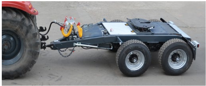
ПІДКАТНИЙ СІДЛОВИЙ ПРИЧЕП ПСП-20 ДОЛЛИ
