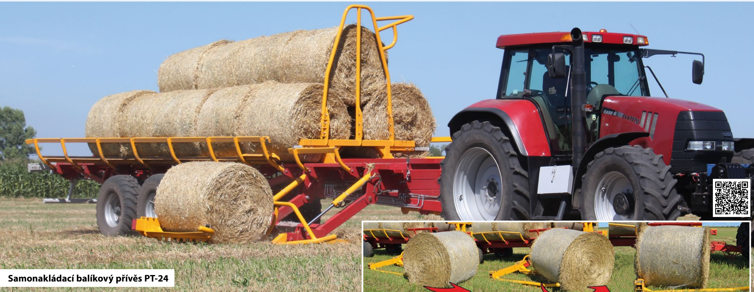
Univerzální hydraulická tlapa na cestách rozloží roli a naloží na plošinu
