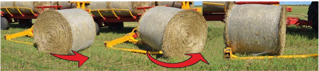
Univerzální hydraulická tlapa na cestách rozloží roli a naloží na plošinu
