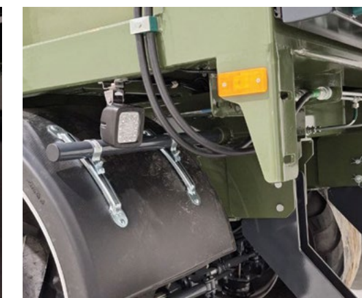
Boční a zadní LED světla pro osvětlení technologické dráhy na hřišti
