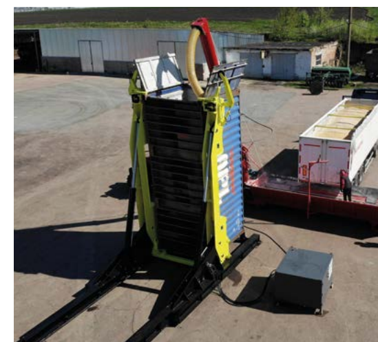
Samodzielnie zdejmuję i instaluje kontener bezpośrednio z kontenerowca
