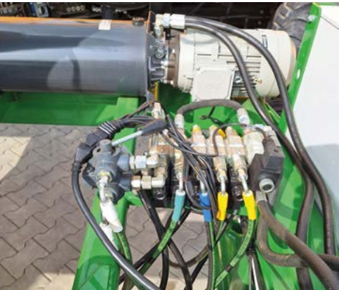
Stacja hydrauliczna z rozdzielaczem hydraulicznym
