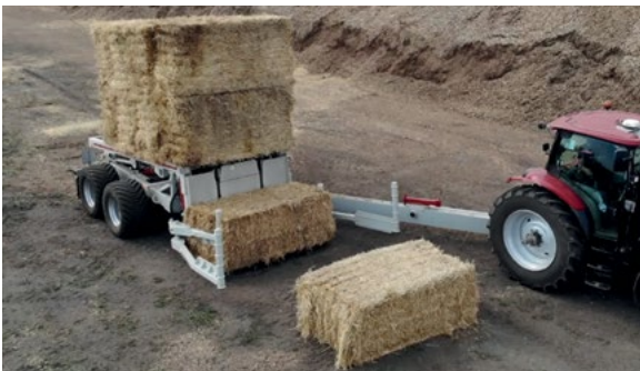
Истовремено подизање две бале
