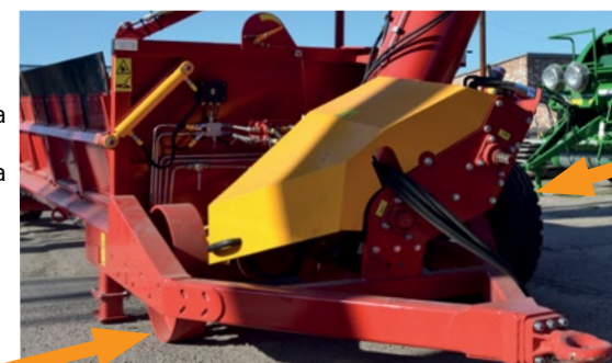
Додатна опција предњих точкова за транспорт зрна резервоар БНП машине
