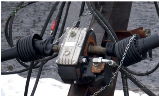
Аутономна нафтна станица на ЗРМ-180. За повећање протока уља на хидрауличном мотору
