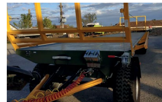
Čekrk i proširenje platforme na 3 m
