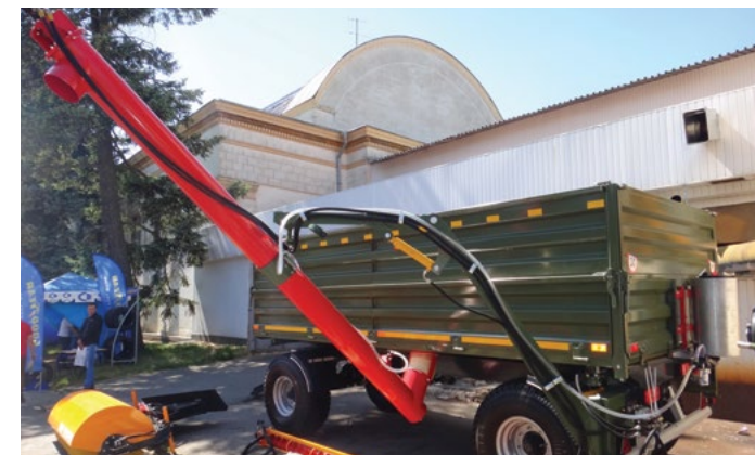
Montirani bočni puž NBSH-250/4
