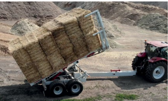
Istovar poluprikolice za bale na ravnoj i čvrstoj površini traje 30-40 sekundi
