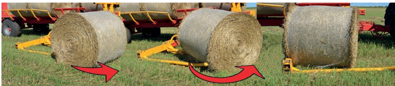
Univerzalni hidraulični utovarač u pokretu obuhvata rolu i utovaruje na platformu
