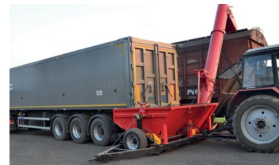
BNP-3 na utovaru vagona paralelno sa vagonom
