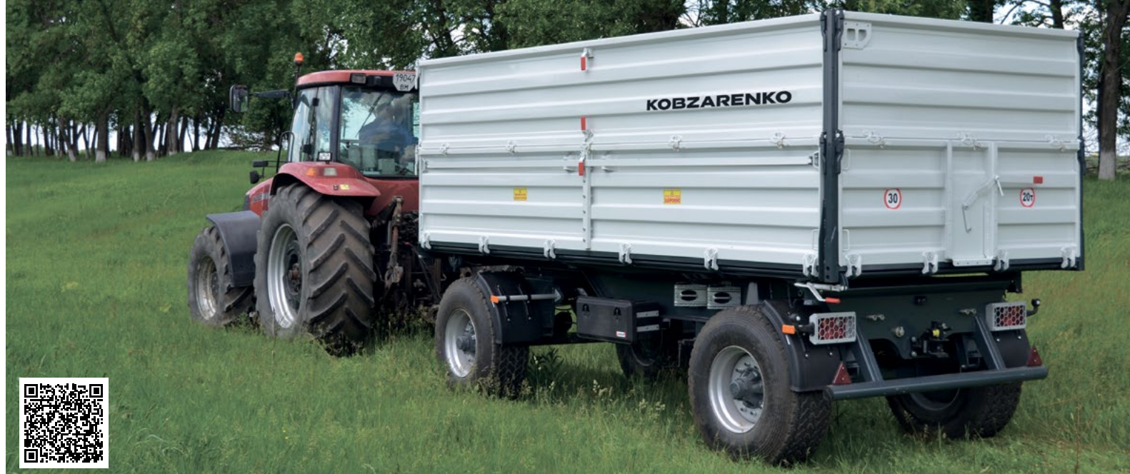
Trostrane prikolice za istovar lako se mogu transformisati u konvencionalnu platformu
