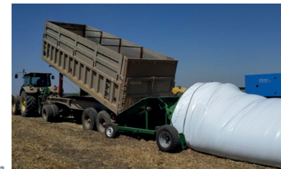
ZPM (A) -180 sa spuštenim spremnikom i elektromotorom. Utovar iz vozila
