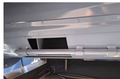
Три капака за почистване на хоризонтален шнек
