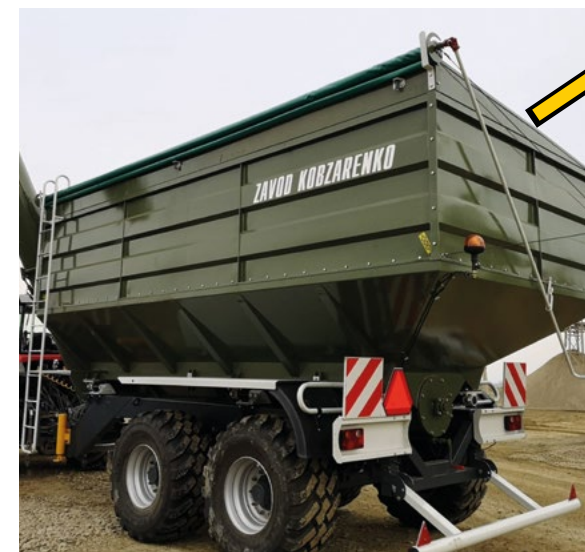
Тентова система (ръчно - с редуктор)
