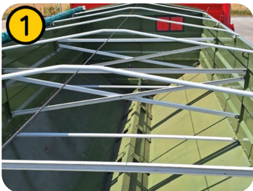
Страните на тялото са придържани заедно посредством мощни разпънки
