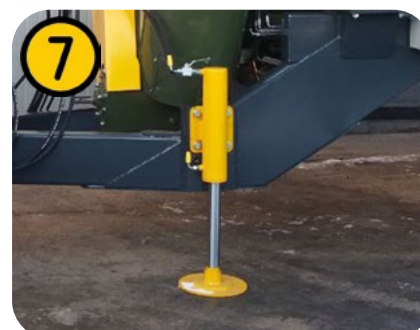
Хидравлична опора на теглича
