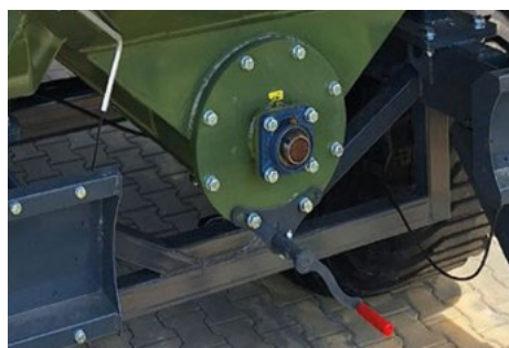
Винтов механизъм за отваряне на капаците за почистване на хоризонталния шнек
