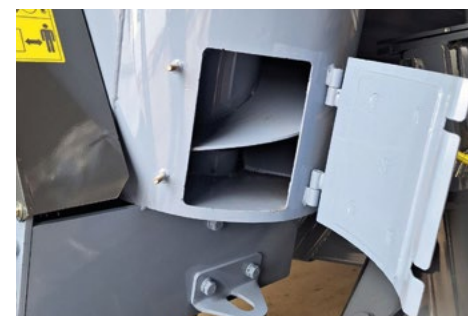
Един люк за почистване на вертикален шнек
