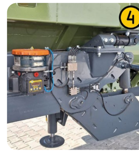
Програмируем компютър с точен интервал на смазване на лагерите
