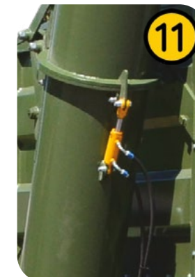
Хидравлично заключване на две шнекови части
