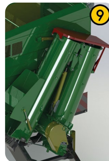
Защитен капак на шнека срещу валежи
