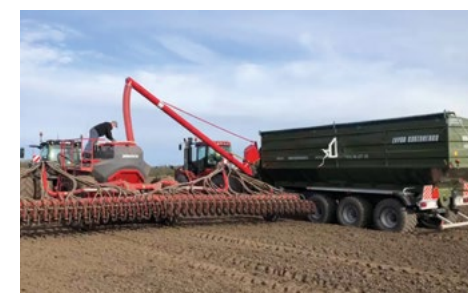
Plnění secích strojů PVC hadicí
