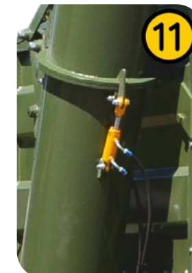
Hydraulický zámek dvou částí šneku
