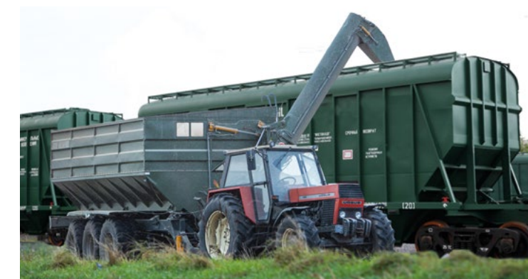
Prodloužený šnek h-5,5 m pro nakládací vozy
