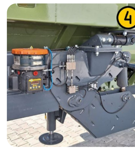
Programovatelný počítač s přesným intervalem mazání ložisek
