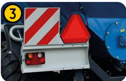
Silniční osvětlení přívěsu dle norem EU
