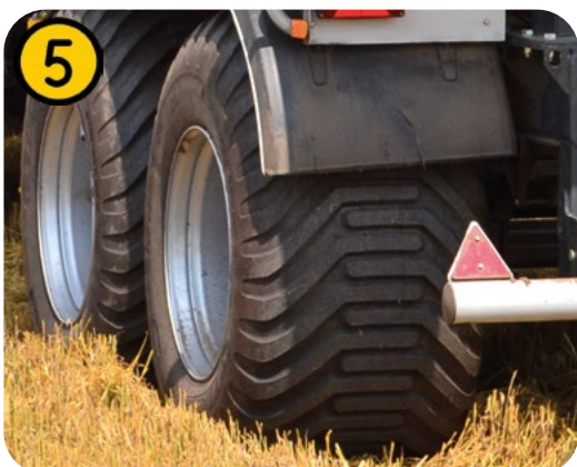
Maximální rozměr kol 850/40R26,5 - Minimální tlak na půdu 1,5 kg/cm 2
