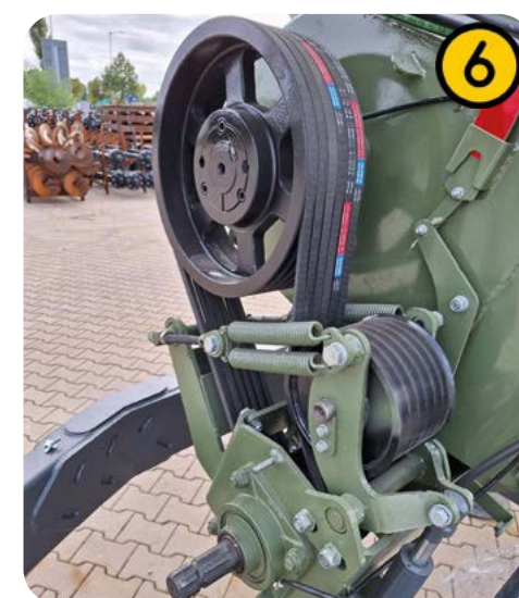
Abu sraigtai varomi atskirai. Vertikalus sraigtas yra varomas nuo reduktoriaus, horizontalus sraigtas nuo diržinės arba grandininės pavaros
