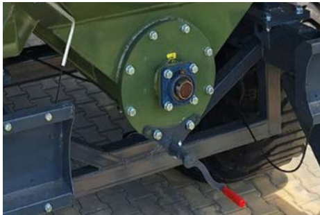
Mechaninis mechanizmas skirtas atidaryti horizontalaus sraigto valymo angas
