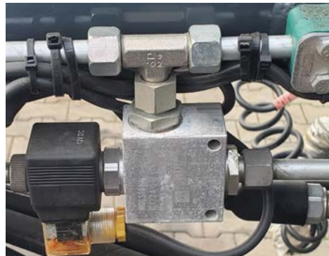
Hidraulinis vožtuvas, ribojantis sklendžių atidarymą
