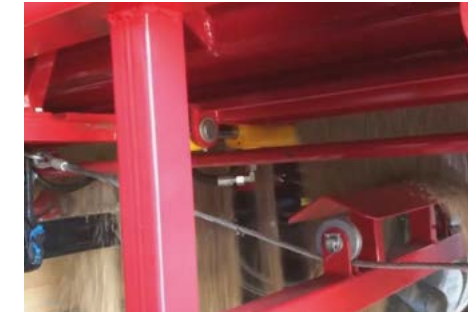
Hidrauliškai valdomos valymo sklendės
