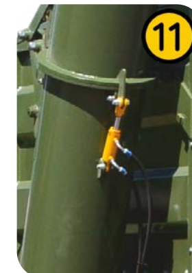
Hidraulinis dviejų sraigto dalių užraktas
