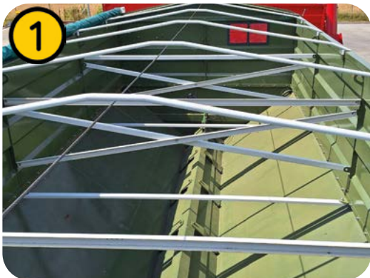
Puspriekabės šonai sutvirtinti tvirtais profiliais
