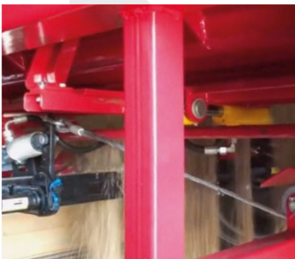
HYDRAULICZNIE STEROWANE KLAPY ŚLIMAKA POZIOMEGO
