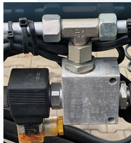
ZAWÓR HYDRAULICZNY BLOKUJĄCY OTWARCIE ZASUWY PRZY ZATRZYMANYM WOM CIĄGNIKA
