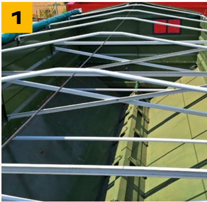
BOKI KORPUSU WZMOCNIONE PROFILAMI
