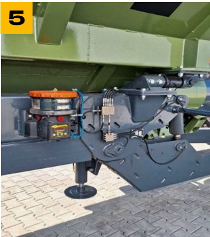
PROGRAMOWALNY KOMPUTER Z PRECYZYJNYM INTERWAŁEM SMAROWANIA ŁOŻYSK
