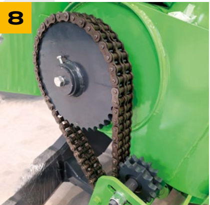
NAPĘD PRZEKŁADNI POPRZEC WAŁEK PRZEKAŹNIKA MOCY
