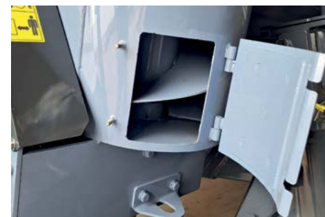
Viena vertikālā gliemežtransportiera tīrīšanas lūka
