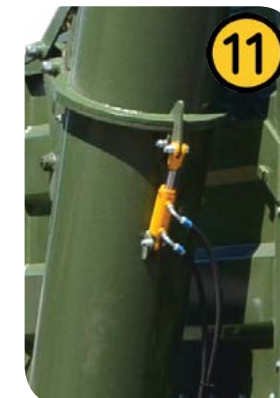
Divu gliemežtransportiera daļu hidrauliska bloķēšana
