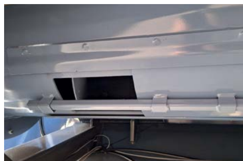
Trīs gliemežtransportiera tīrīšanas lāpstiņas
