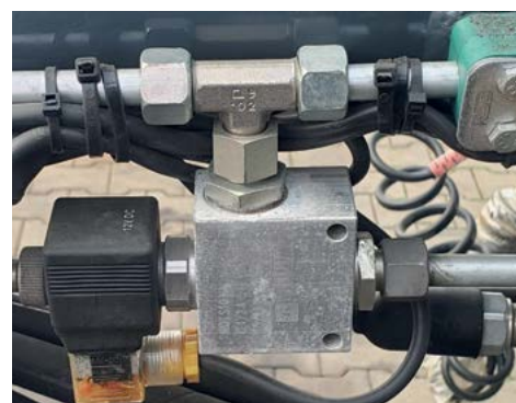
Hidrauliskais vārsts, kas nepieļauj aizbīdņa atvēršanu, ja piestiprināta jūgvārpsta.
