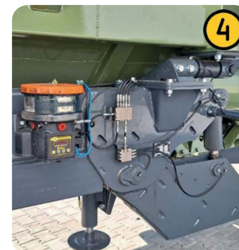
Programmējams dators ar precīzu gultņu eļļošanas intervālu
