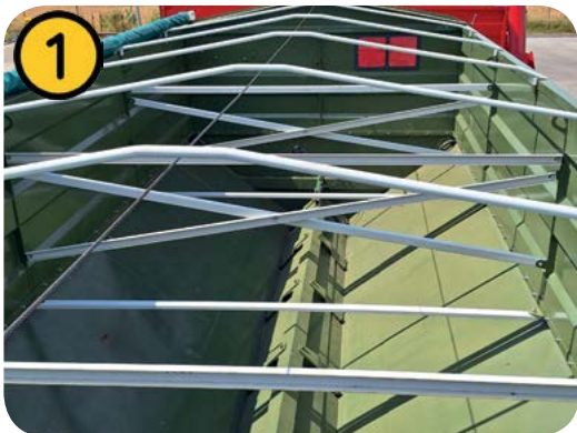
Korpasa daļas kopā tiek sastiprinātas ar izturīgiem profila distanceriem.
