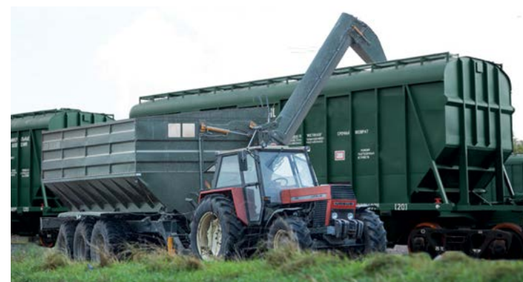
Pagarināts gliemežtransportieris h = 5,5 m vagonu iekraušanai
