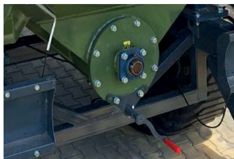
Horizontālā gliemežtransportiera tīrīšanas lāpstiņu atvēršanas skrūves mehānisms
