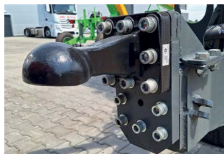
Augstuma regulēšana piekabīšanai jebkuram traktoram
