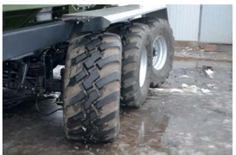
Hidrauliski stūrējama priekšējā un aizmugures asis
