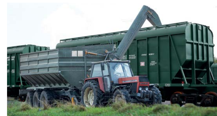
Prodloužený šnek h-5,5 m pro nakládací vozy
