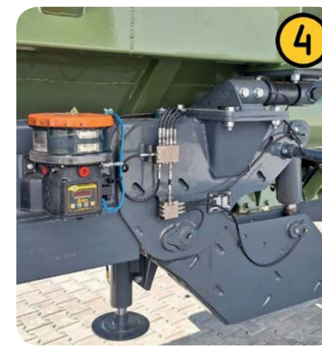
Programovatelný počítač s přesným intervalem mazání ložisek
