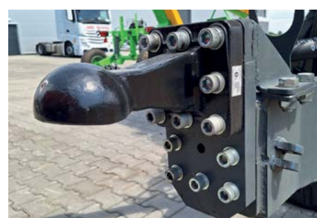
Adaptér pro nastavení výšky pro připojení k jakémukoli traktoru
