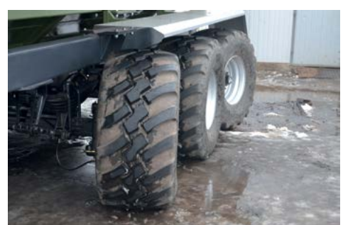
Hydraulicky řízená první a poslední náprava (PBN-40 a PBN-50)
