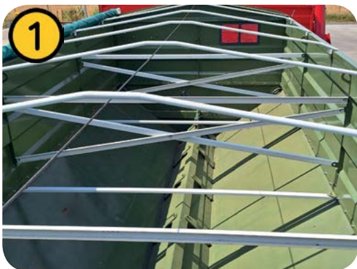
Bočnice skříň jsou k sobě staženy pevnými profilovými rozpěrami
