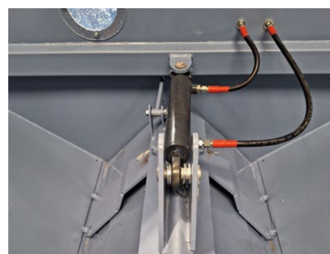
Un cancello scorrevole che si apre idraulicamente. Alimenta il grano in una coclea.
