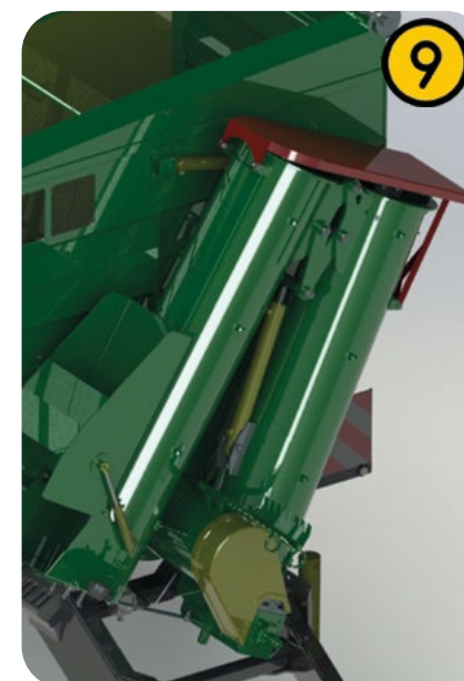
Copertura protettiva della coclea contro le precipitazioni
