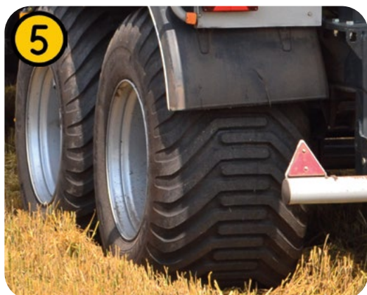
Misura massima della ruota 850/40R26.5 - Pressione minima al suolo 1,5 kg/cm 2
