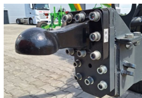
Adattatore per la regolazione dell'altezza per l'attacco a qualsiasi trattore
