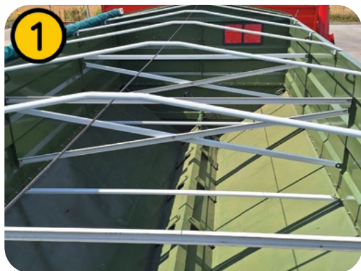
I lati del corpo sono uniti da potenti distanziatori del profilo
