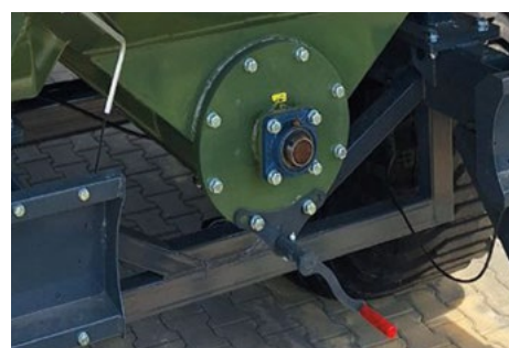
Meccanismo a vite di apertura orizzontale sportello di pulizia della coclea
