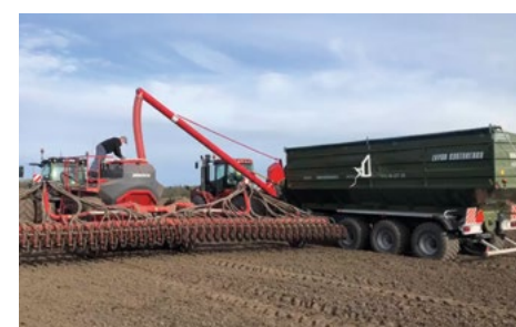
Caricamento seminatrici tramite tubo in PVC
