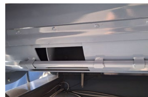
Tre alette di pulizia della coclea orizzontale
