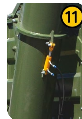
Blocco idraulico di due parti della coclea
