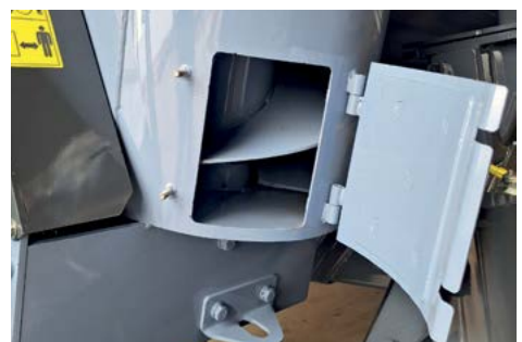
Nyitható ajtó a függőleges csiga tisztításához
