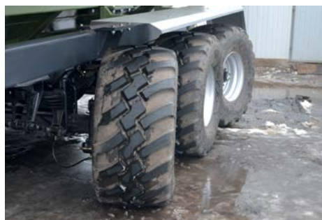
Hidraulikus kényszerkormányzású mellső és hátsó tengely (PBN-40 és PBN-50)
