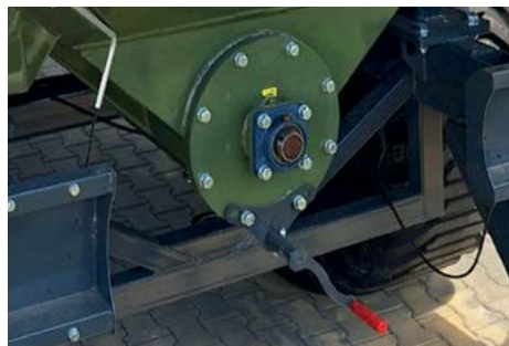
Mechanikus nyitómechanizmus a vízszintes csiga tisztításához
