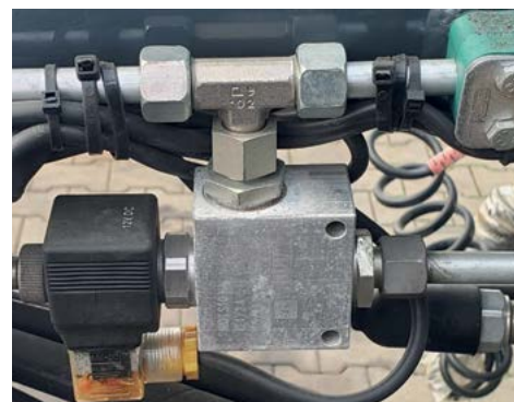
Hidraulikus szelep a tolózár nyitásának blokkolására rögzített traktor TLT-vel.
