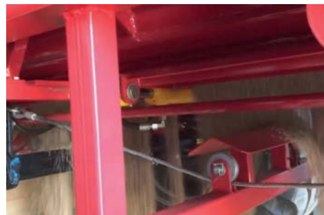
Hidraulikus nyitású tisztító zsalu
