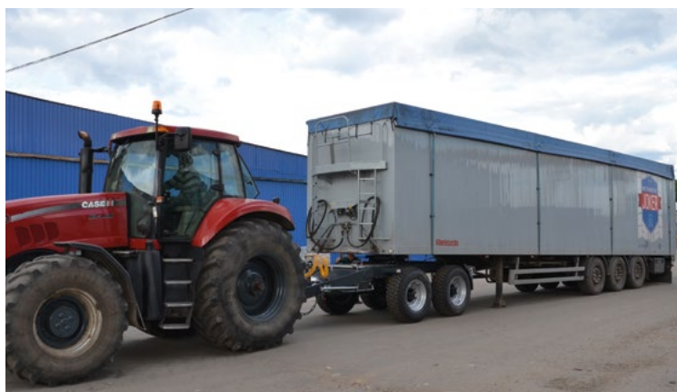
Spojení PSP-20 Dolly s nákladním návěsem a tahačem
