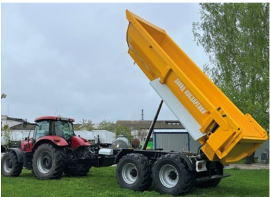
Teleskopický hydraulický válec DiNatale (Itálie)
