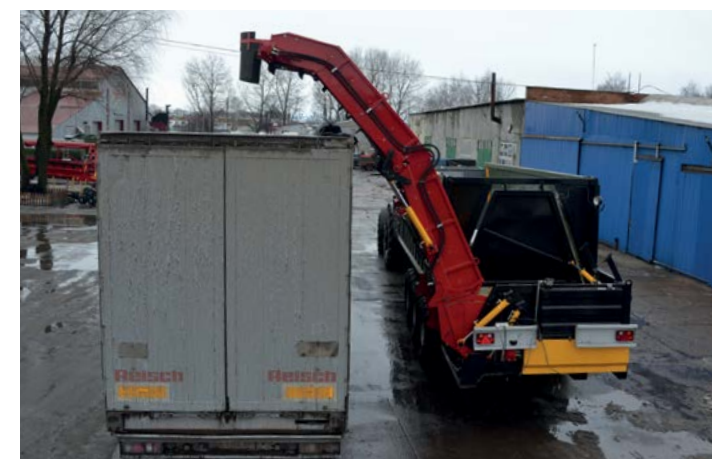
Biešu pārkraušana augstumā līdz 4,5 m.
