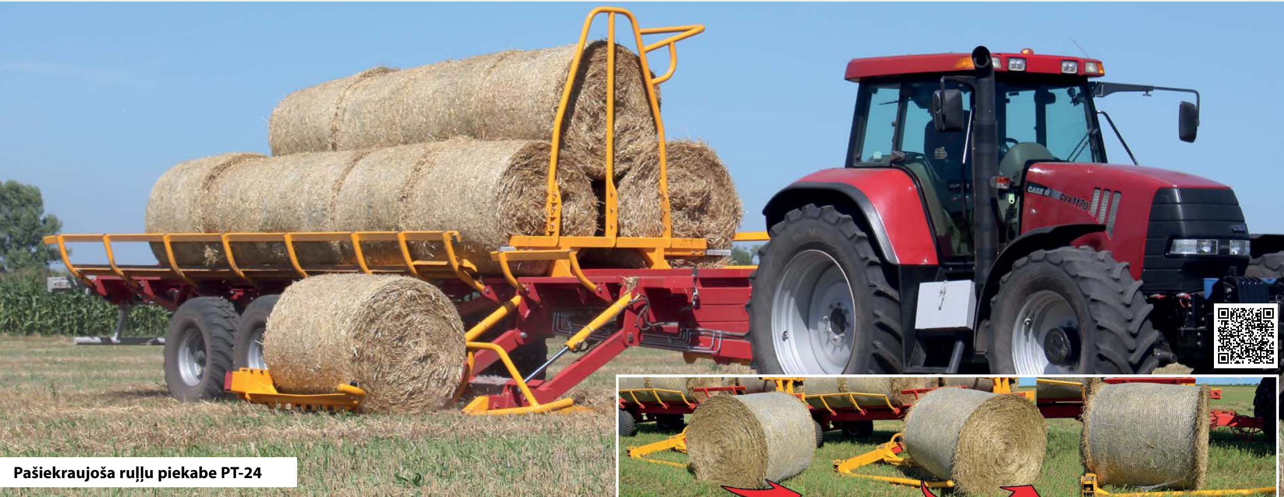
Universālais hidrauliskais pacelājs kustībā savāc rulli un ievieto platformā.
