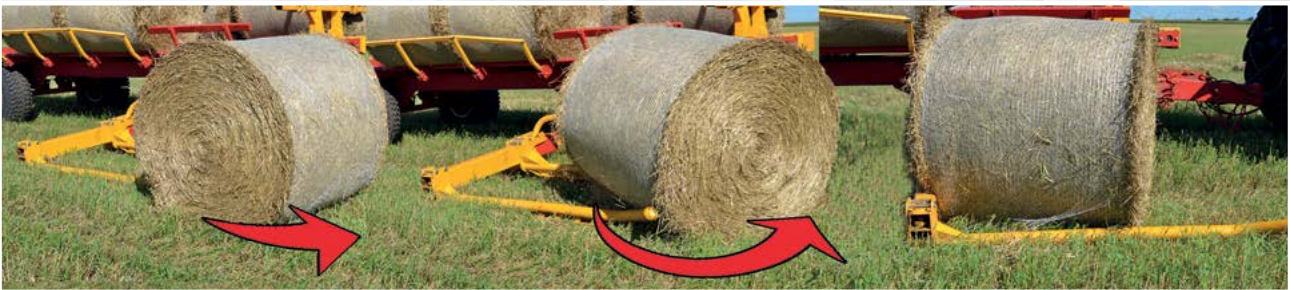
Universālais hidrauliskais pacelājs kustībā savāc rulli un ievieto platformā.
