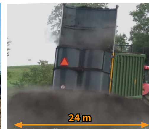
Kūtsmēsli izklienēšana ar plāksnēm. Aizvērts aizmugures borts
