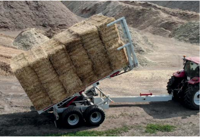
Ķīpu puspiekabes izkraušana uz stabilas virsmas nepieciešamas 30-40 sekundes.
