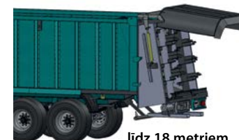
Papildspēja: aizmugures borts kūtsmēsli un putnu mēsli izklienēšanai ar apakšējām plāksnēm (izklienēšana līdz 24 m).
