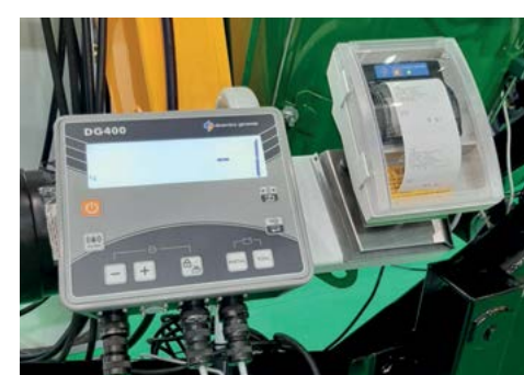
Dinamica Generale (Itālija) svēršanas sistēma
