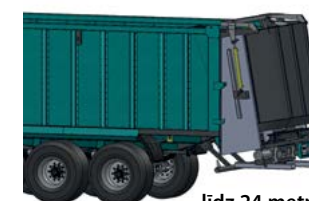
Papildspēja: aizmugures borts kūtsmēsli un putnu mēsli izklienēšanai ar apakšējām plāksnēm (izklienēšana līdz 24 m).
