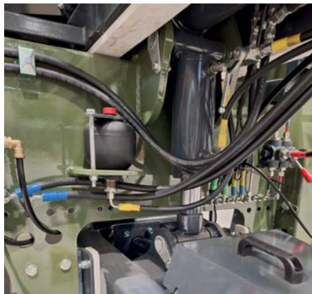
Jūgstienis ar hidraulisku augstuma regulēšanu un hidraulisku amortizatoru ar hidraulisko akumulatoru.
