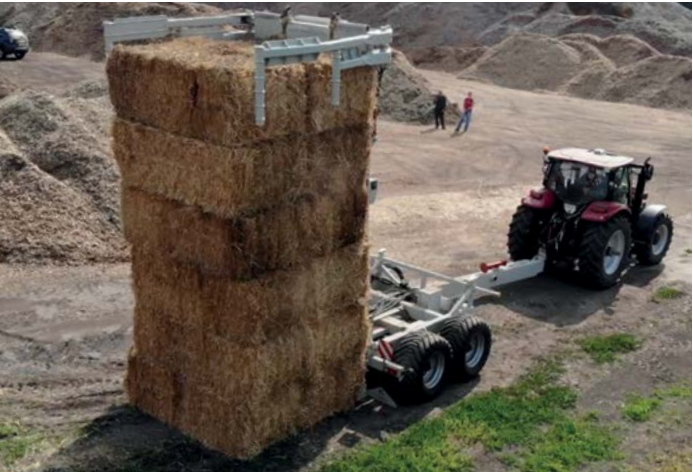
Ķīpu izkraušana bez papildu aprīkojuma.
