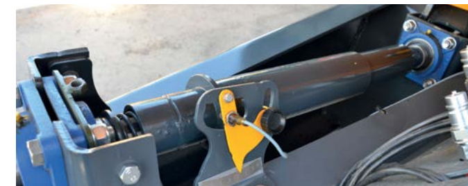
Torsionu slodzes uzraudzība, kas maksimālas slodzes brīžos aptur plūsmu un izklienētājiem un bloķē eļļas padevi uz hidraulisko cilindru.
