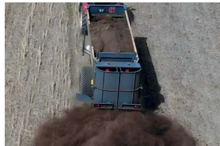
Organiskā mēslojuma iestrāde ar apakšējām plāksnēm - minimāla izkļiedes pakāpe
