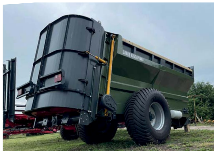
Aizmugures borts ir atverams hidrauliski.
