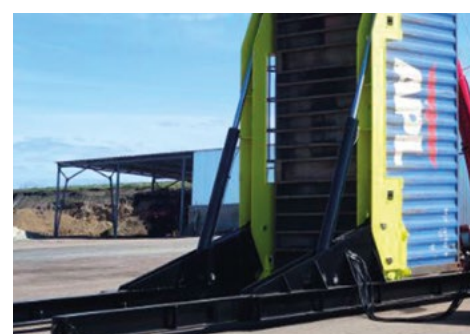
Vyztužené hydraulické válce pro zvedání / spouštění
