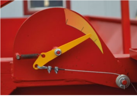
Stupnice, která ukazuje otevření posuvné clony
