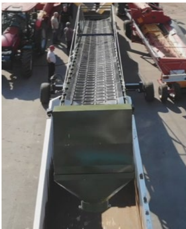
Ševronový pás ve tvaru V 1 200 mm nepoškozuje zrno
