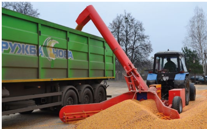
Ricaricamento del grano nel trasportatore di cereali NRU-180
