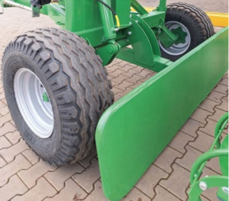
Urto protettivo che impedisce alle ruote di colpire la borsa
