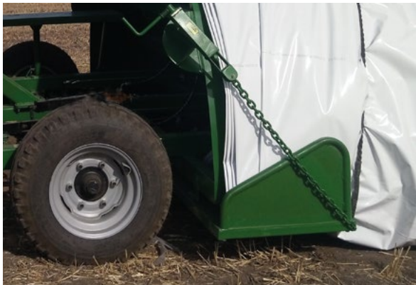
Regolazione del vassoio portasacco
