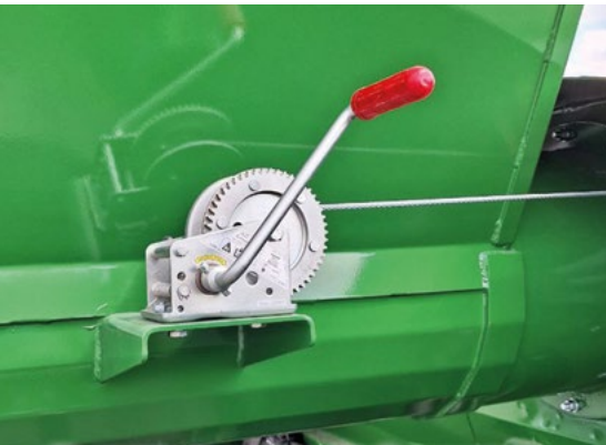
Un argano manuale per il sollevamento del sacco
