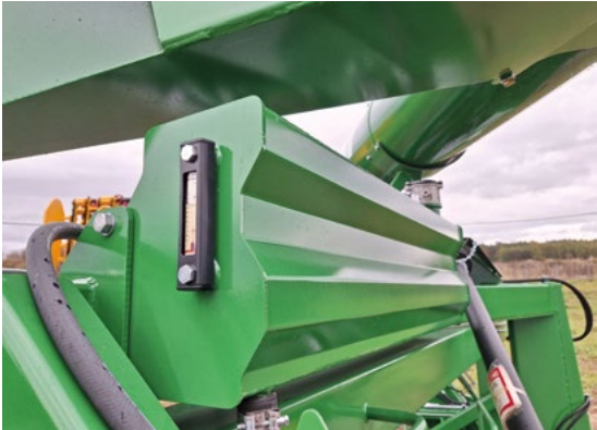
Serbatoio olio aggiuntivo con termometro
