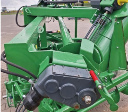
Meccanismo di avvolgimento e rimozione del sacchetto
